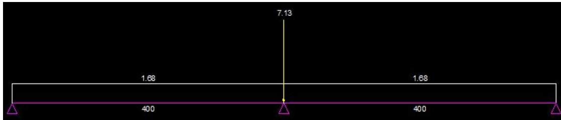
Figura 10.4 – Carregamento da viga 200.
