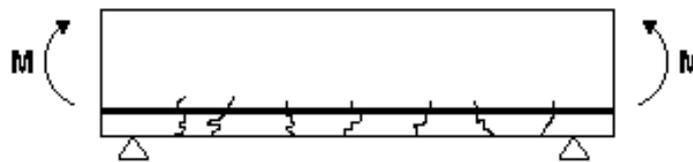
Fig. 1.1 – viga de concreto armado convencional, onde se admite fissuração para efeito de cálculo.
