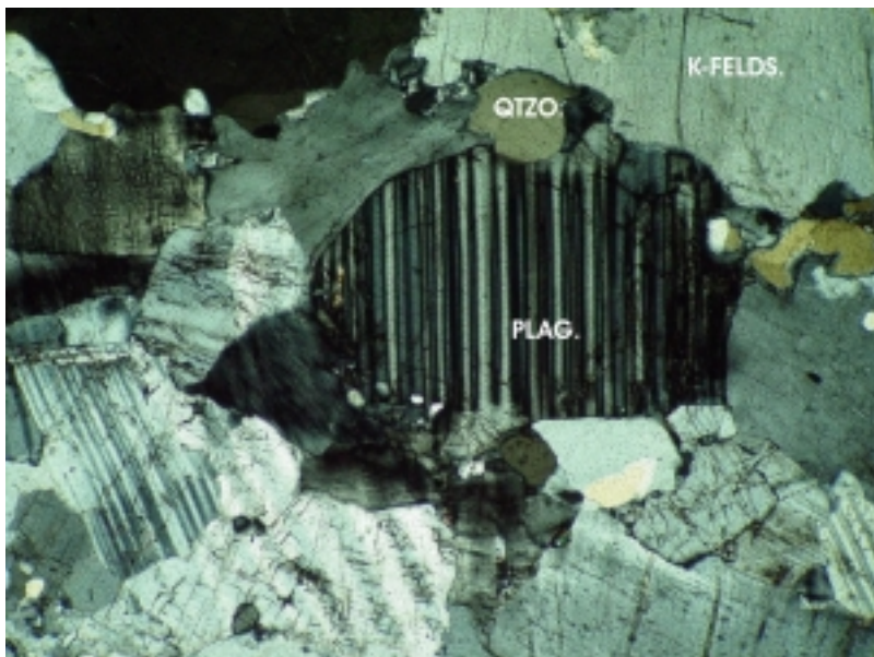
Figura 11 – Visão geral da lâmina com grãos de quartzo (QTZO.); alcali-feldspato (K-FELDS.) e plagioclásio (PLAG.).
