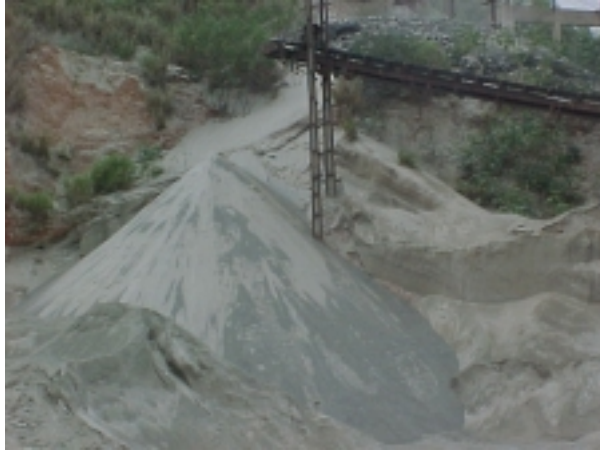
Foto 1 - Pilha de finos resultante da britagem de rocha - Pedreira Itereré .
