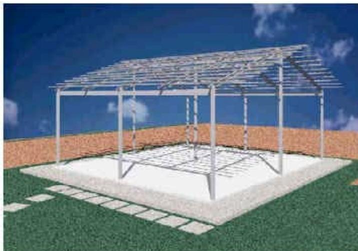
Figura 1 – Estrutura metálica típica de casa popular
