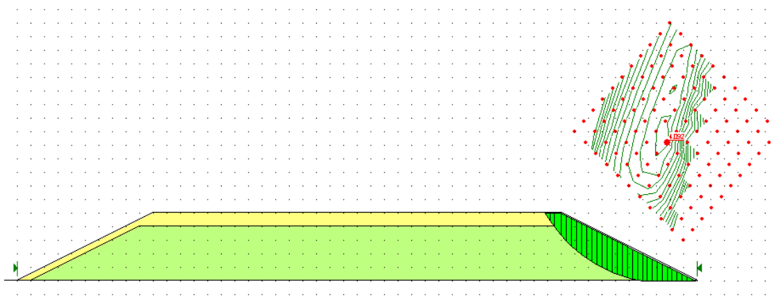
Figura 8.1 – Verificação da estabilidade do talude.
