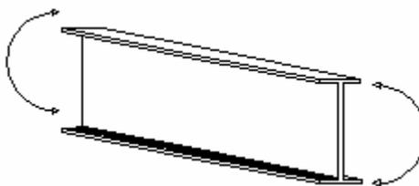
Figura 33 – Esquema do perfil I com solda.
