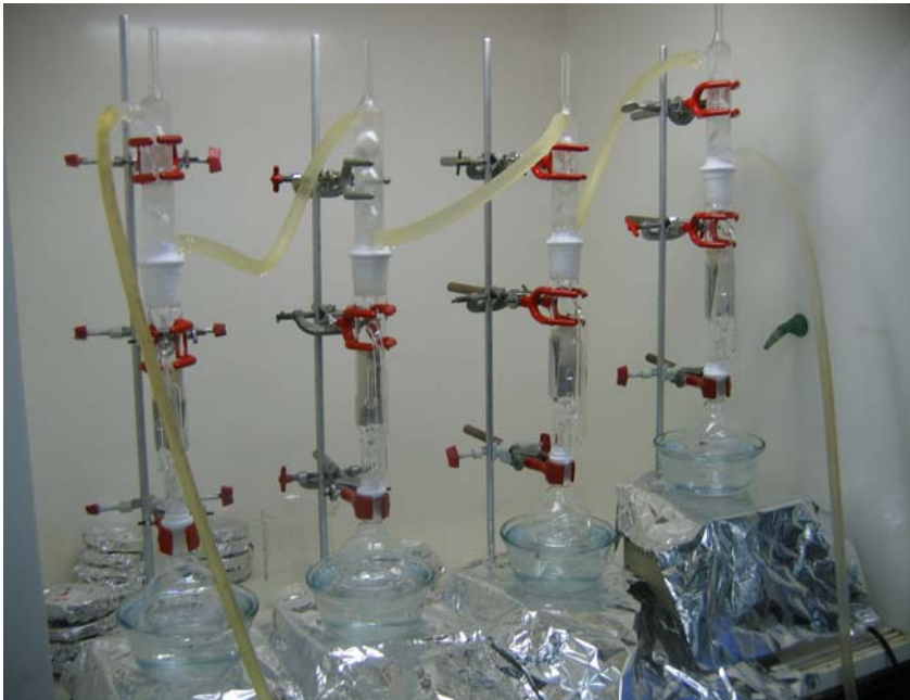
Figura 4.2 - Extração de pesticidas utilizando o sistema soxhlet
