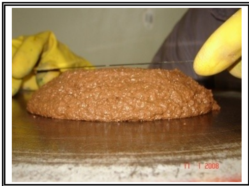
Figura 4.4 - Ensaio de consistência-padrão em argamassa geopolimérica.
