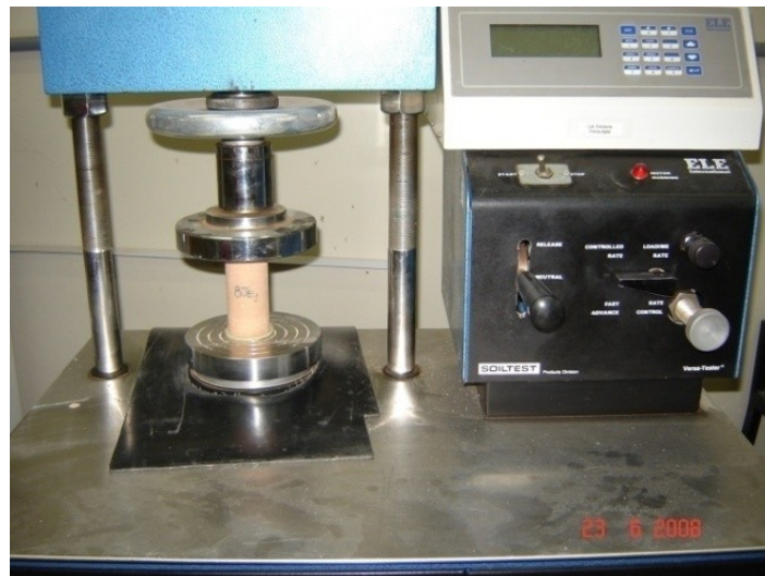
Figura 4.8 - Prensa Versa Tester para realização do ensaio de compressão axial.
