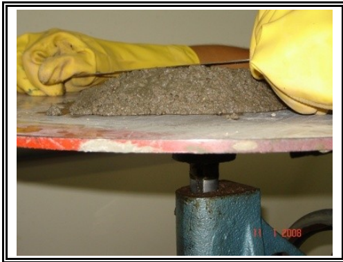
Figura 4.3 - Ensaio de consistência-padrão em argamassa de cimento Portland.
