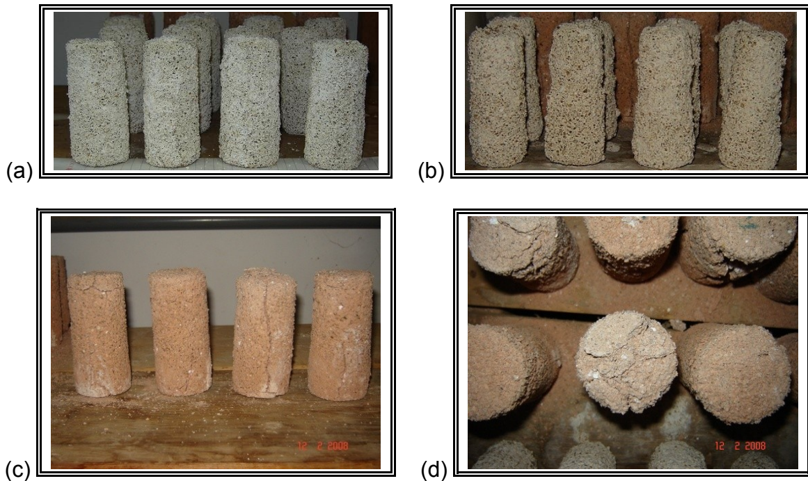
Figura 4.6 - Corpos-de-prova sob ação da solução de ácido sulfúrico a 10% de concentração: (a) e (b) Argamassa de cimento Portland; (c) e (d) Argamassa de cimento geopolimérico.
