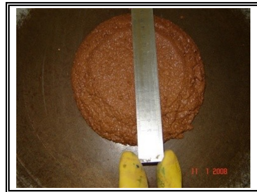
Figura 4.4 - Ensaio de consistência-padrão em argamassa geopolimérica.
