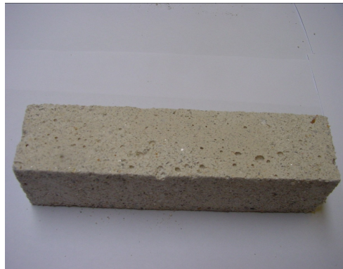
Figura 3.13 - Corpo-de-prova de cimento geopolimérico após ataque por ácido sulfúrico (PINTO, 2004).
