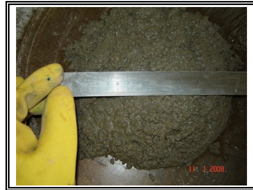
Figura 4.3 - Ensaio de consistência-padrão em argamassa de cimento Portland.
