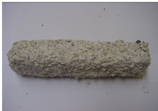
Figura 3.12 - Corpo-de-prova de cimento Portland após ataque por de ácido sulfúrico (PINTO, 2004).
