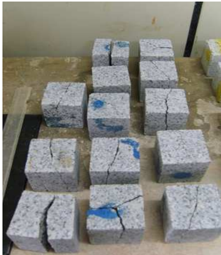
Figura 16- Blocos rompidos- AZ
