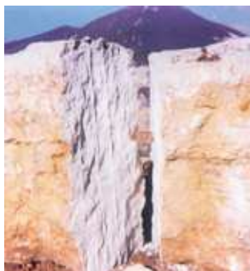
Figura 10– Blocos extraídos com aplicação de agente expansivo.
