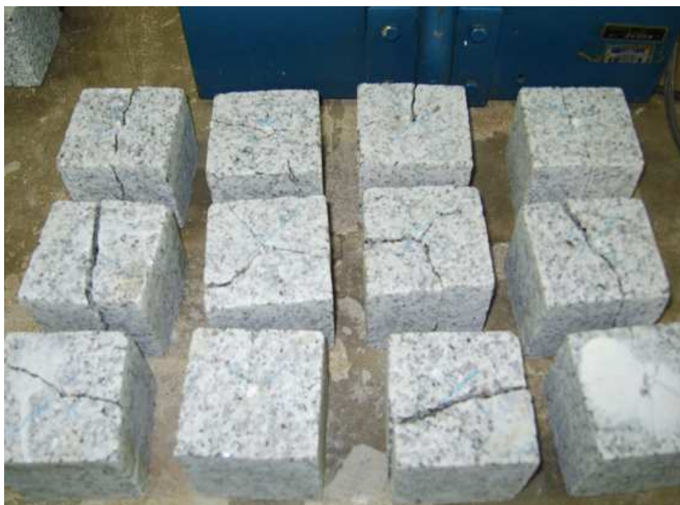
Figura 17- Blocos rompidos- BR
