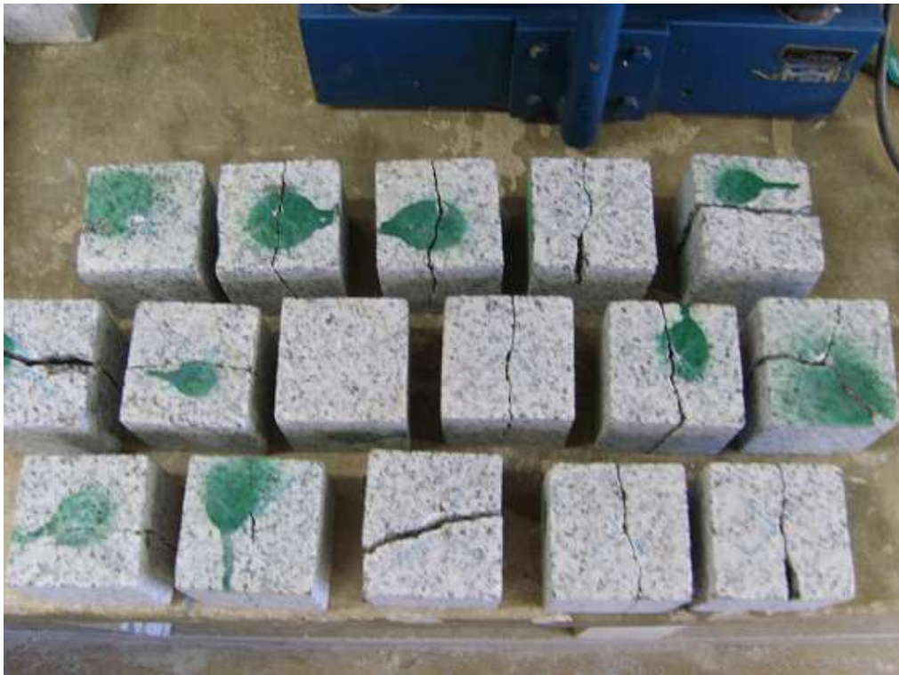
Figura 20- Blocos rompidos- VD
