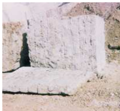
Figura 10– Blocos extraídos com aplicação de agente expansivo.
