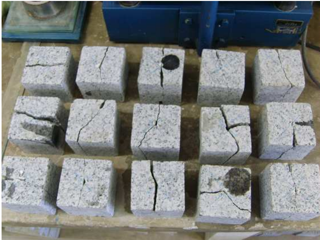
Figura 19- Blocos rompidos- PR
