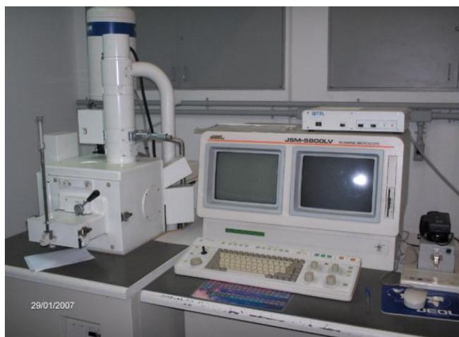
**Figura 3.16 – Microscópio Eletrônico de Varredura (JEOL JSM – 5800 LV).**
