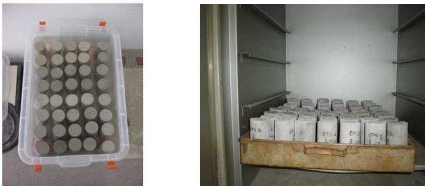
**Figura 3.15 – Corpos-de-prova durante o ensaio de ciclagem água-estufa.**
