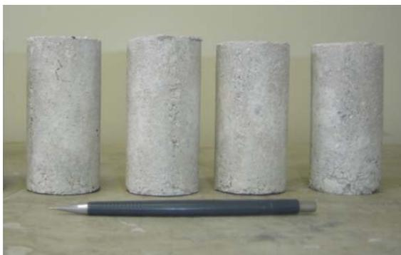
**Figura 3.7 – Corpos-de-prova utilizados para a determinação da densidade de massa aparente.**
