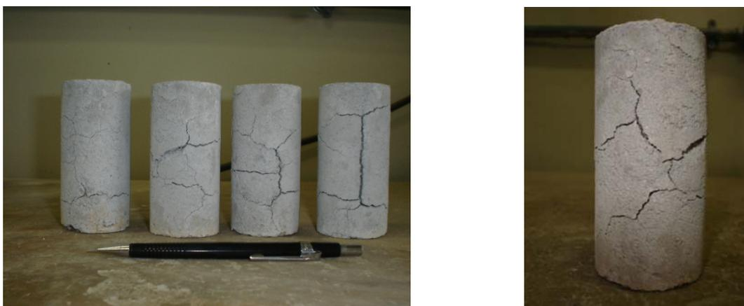
**Figura 4.19 – Condições dos corpos-de-prova de argamassa com EFS B após ciclagem água-estufa.**
