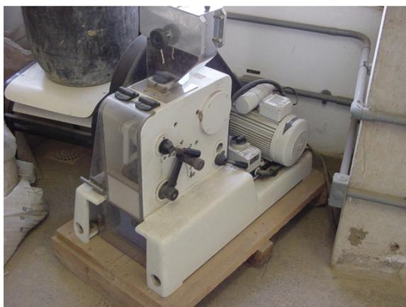
**Figura 3.1 – Triturador de mandíbulas utilizado.**
