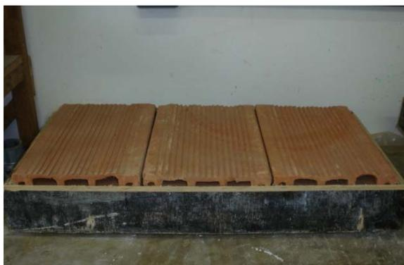
**Figura 3.10 – Superfície utilizada no ensaio de resistência de aderência.**
