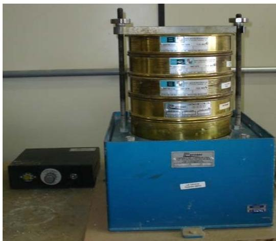
**Figura 3.2 – Peneirador mecânico.**
