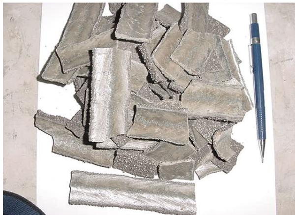
**Figura 2.6 – EFS destacada da soldagem.**
