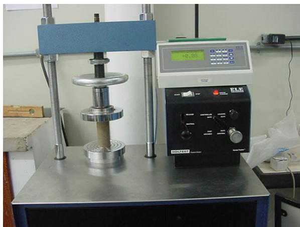
Figura 3.8 – Prensa utilizada no ensaio de resistência à compressão.
