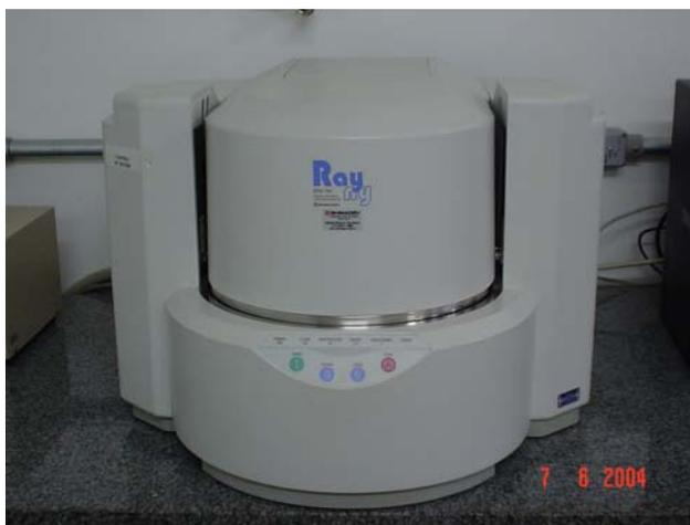
**Figura 3.3 – Equipamento Shimadzu EDX-700**
