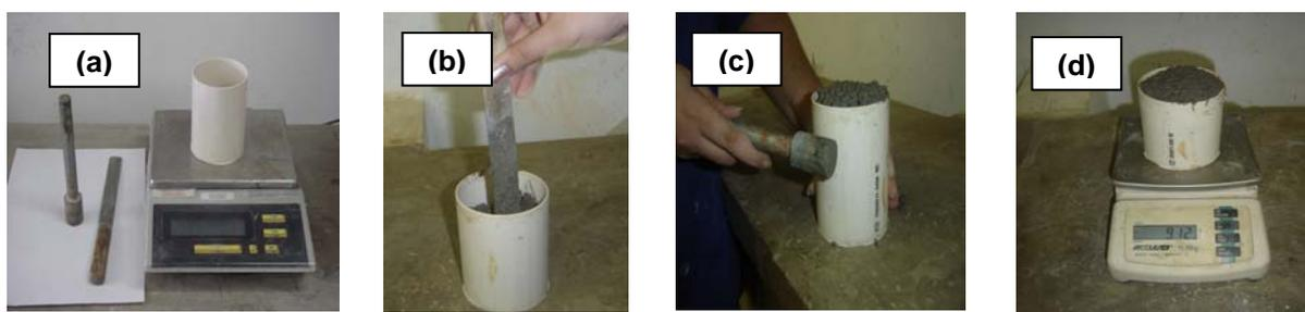
**Figura 3.5 – Procedimento do ensaio de densidade de massa e de teor de ar incorporado: (a) equipamentos utilizados no ensaio; (b) compactação com a espátula; (c) compactação com soquete; (d) medição da massa no recipiente.**
