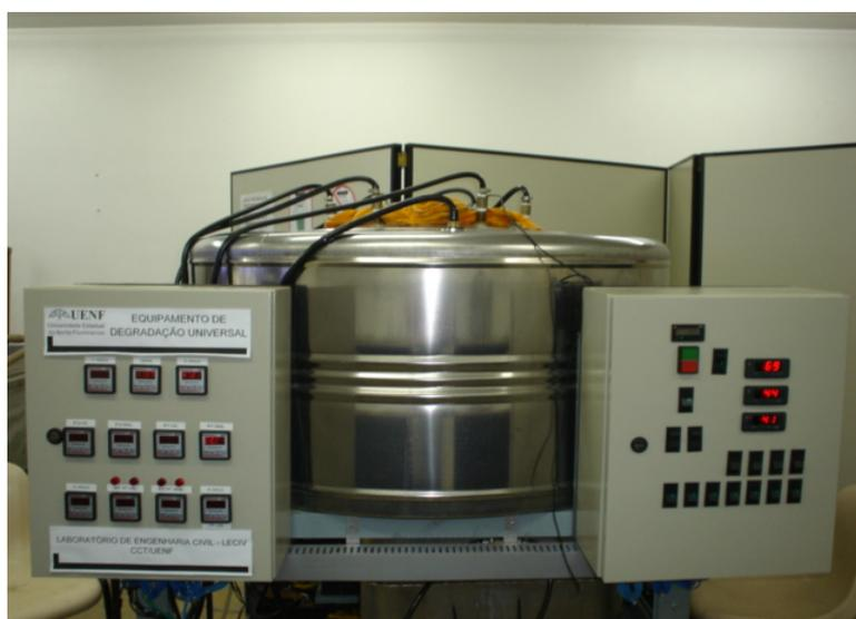
**Figura 3.13 – Aparelho de lixiviação contínua.**
