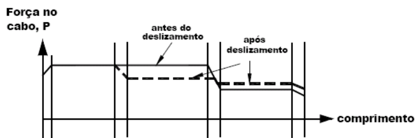
Figura 2.7 – Tensão no cabo após o deslizamento (PERLINGEIRO, 2006).
