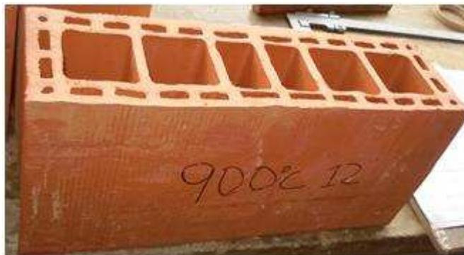
Figura 3.11 - Bloco sem defeitos aparentes escolhido para ensaio.
