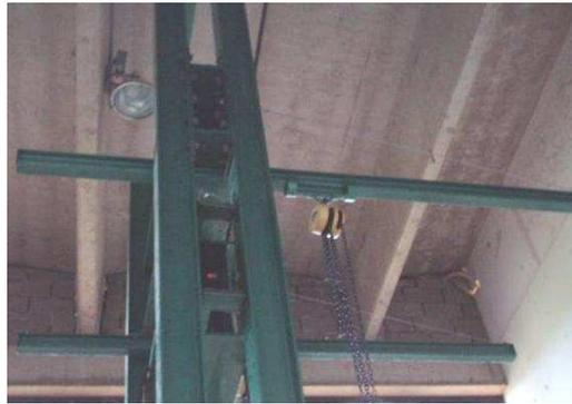
Figura 3.24 - Ponte móvel acoplada ao pórtico metálico da prensa.
