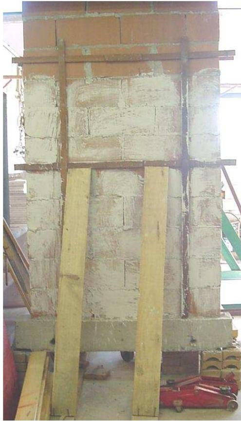
Figura 3.22 - Alvenaria sobre viga de transporte com apoios nas extremidades.
