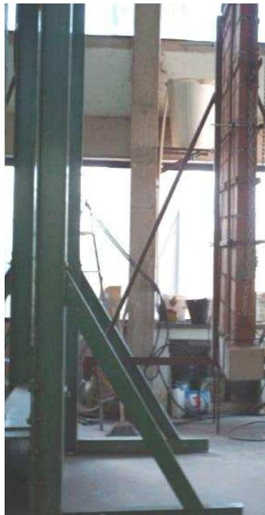
Figura 3.25 - Painel de parede erguido pela ponte móvel da prensa.
