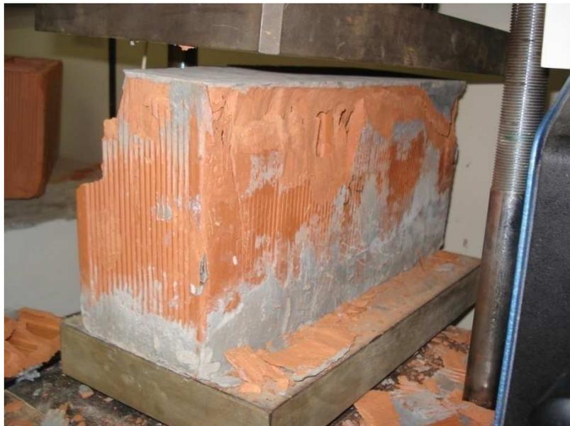
Figura 5.12 - Bloco rompido à compressão simples.
