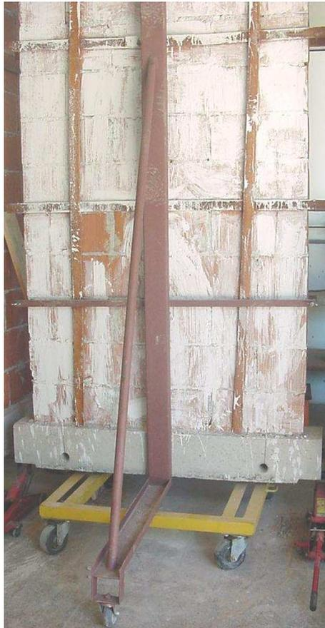
Figura 3.23 - Plataforma com alvenaria acomodada e contraventada.
