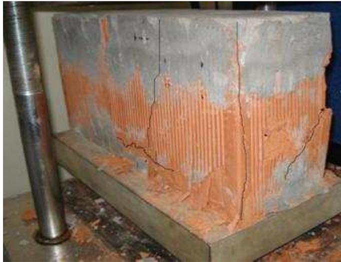
Figura 4.20 - Bloco em rompido à compressão simples.
