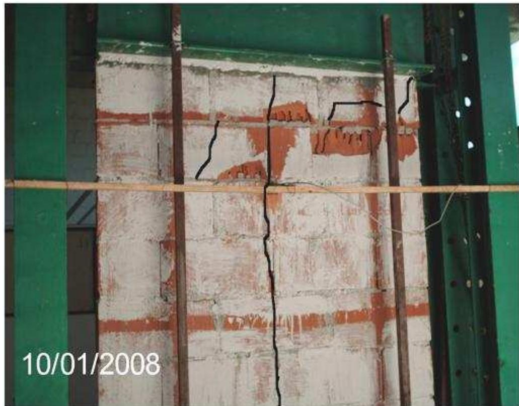
Figura 4.25 - Parede fissurada.
