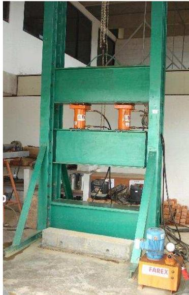
Figura 3.17 - Prensa com acionador servo-hidráulico duplo.
