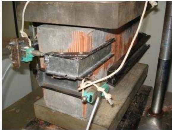
Figura 3.16 - Bloco com LVDT's fixados.
