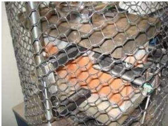
Figura 4.19 - Bloco pronto para ensaio a compressão simples.
