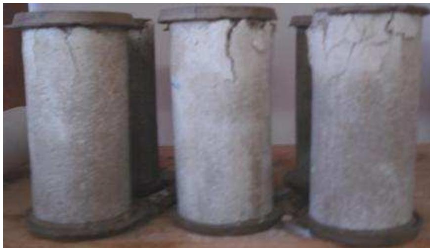
Figura 4.22 - Corpos-de-prova de argamassa
