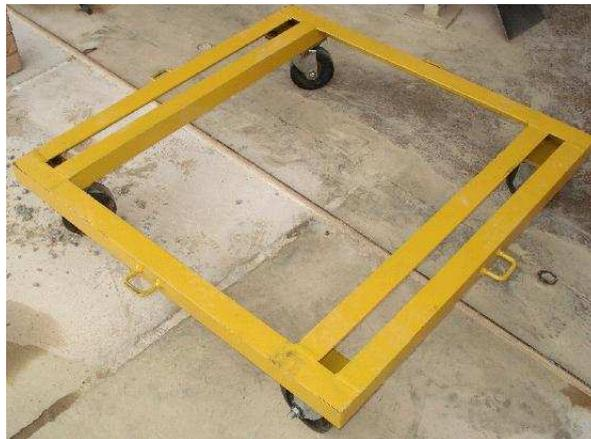
Figura 3.21 - Plataforma metálica utilizada para transporte da alvenaria.
