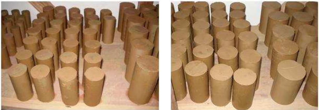
Figura 3.3 - Corpos de prova moldados por extrusão.
