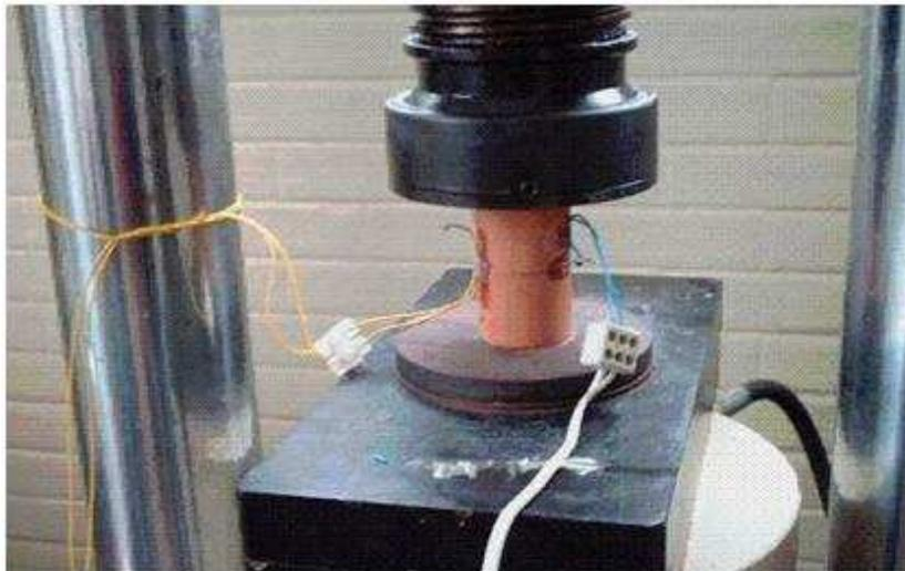
Figura 3.9 - Corpo-de-prova cerâmico (diâmetro de 6 cm) com extensômetros.
