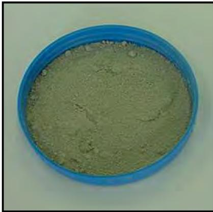
Fig. 3.9 - RCR antes dos ciclos de molhagem e secagem
