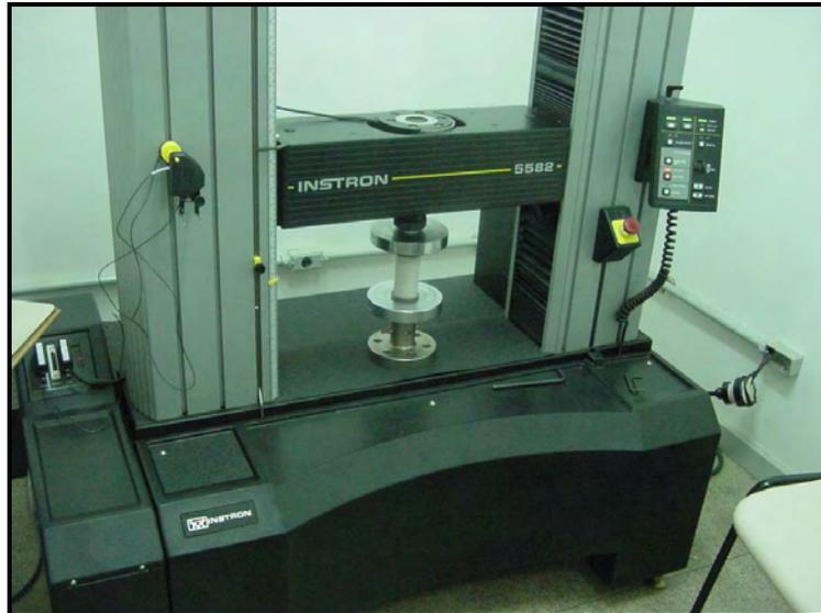
Fig. 3.47 - Montagem para ensaio à compressão em prensa eletrônica Instron 5582
