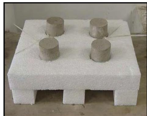
Fig. 3.43 - Suporte flutuante com os corpos-de-prova
