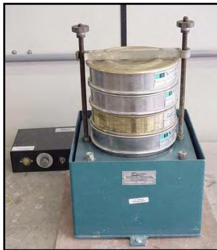
Fig 3.4 - Peneirador mecânico
