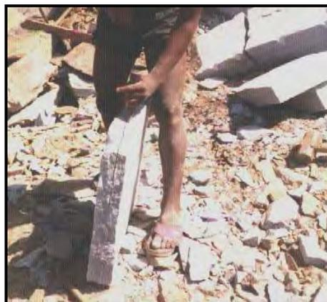
Fig. 2.9 - Deslocamento dos blocos em lajes (adaptada de OLIVEIRA, 1998)
