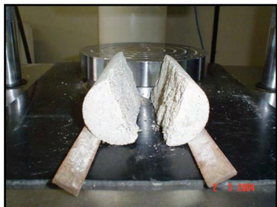
Fig. 3.40 - Forma típica de ruptura dos corpos-de-prova
