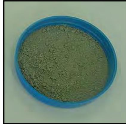
Fig. 3.10 - RCR depois dos ciclos de molhagem e secagem
