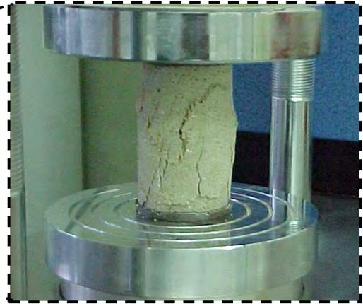
Fig. 3.21 - Detalhe da ruptura dos CPs
