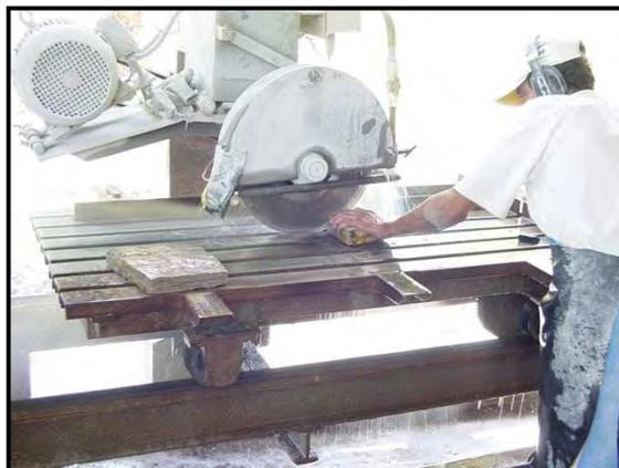
Fig. 2.13 - Máquina de corte com disco diamantado
