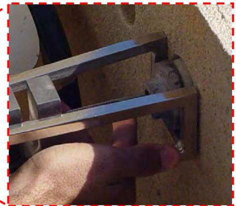
Fig.3.37 - Detalhe do acoplamento do aparelho ao revestimento
