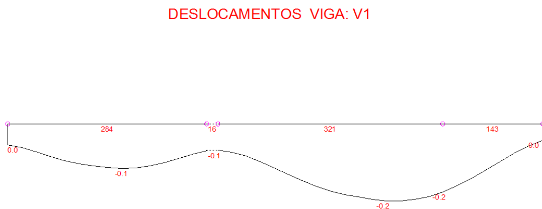
Figura 6.7 - Diagrama de deslocamentos das Vigas em centímetros
