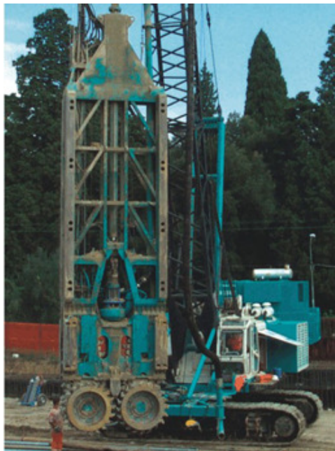
Figura 6 – Hidrofresa: utilizada em escavações em rocha (FONTE: Costa Fortuna, 2014).
