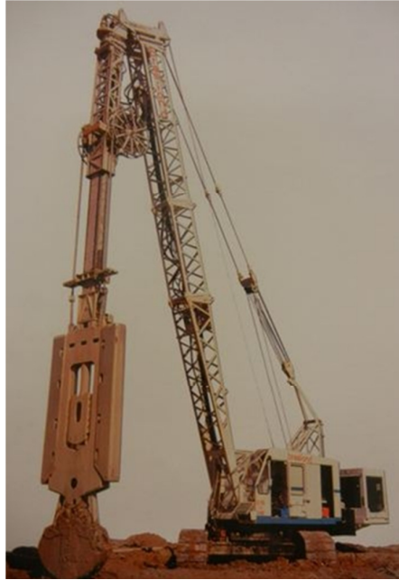
Figura 5 - Diafragmadora: clam-shell e guindaste principal (FONTE: Naresi e Hielber, 2014).
