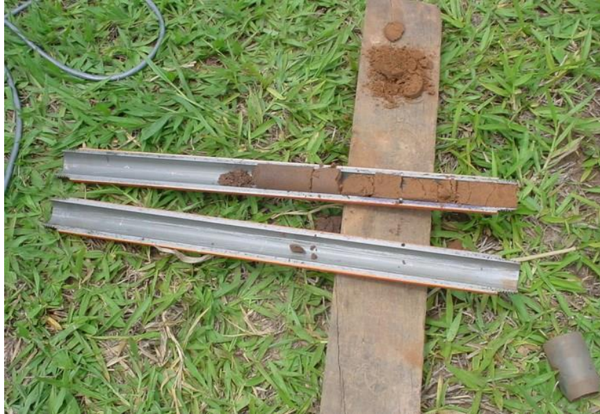
Figura 6 – Amostrador da sondagem à percussão
