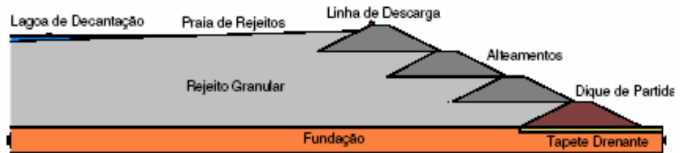
Figura 1 - Método Construtivo de Montante (FONTE: ALBUQUERQUE FILHO, 2004 por ARAUJO, 20006).
