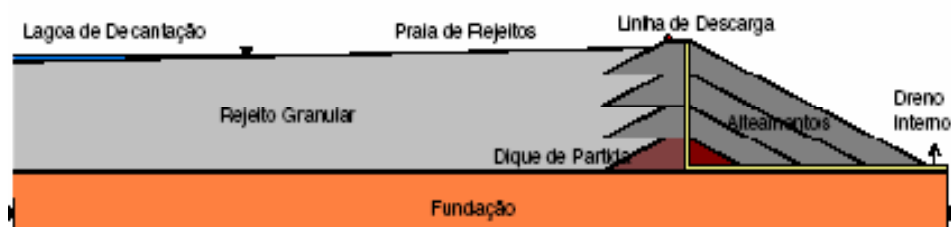
Figura 3 - Método Construtivo de Linha de Centro (FONTE: ALBUQUERQUE FILHO, 2004 por ARAUJO, 2006).
