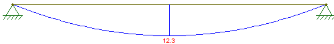
Figura 3.23- Diagrama de momento fletor da viga V1 (Tipo).
