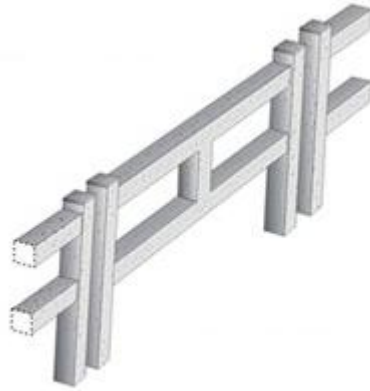
Figura 2.1 - Vista em perspectiva do guarda corpo
