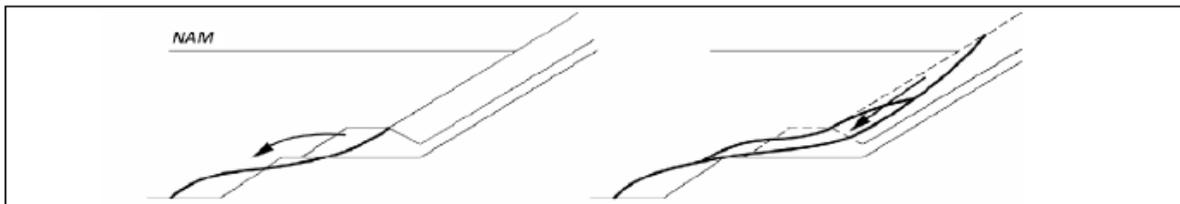
Figura 3.20: Erosão da risberma e deslizamento do manto resistente (PEREIRA, 2008b).
