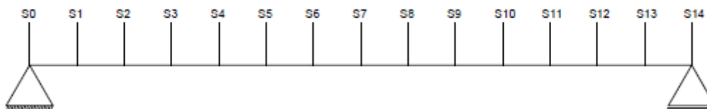
Figura 3.58: Seções da cortina para cálculo das combinações.
