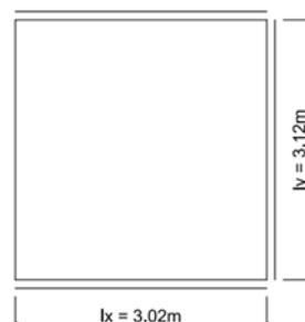
Figura 3.40: Representação do vínculo da laje biengastada, baseada na tabela de Rüsçh.
