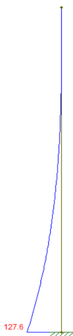
Figura 3.72: Diagrama de momento gerado pela força do empuxo de terra sobre a direção l_y da ala.
