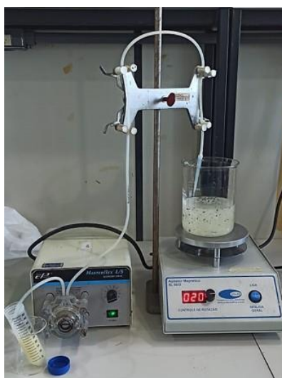
Figura 6: Encapsulamento do óleo. Bomba peristáltica Masterflex®, Cole Parmer®, agitador magnético, mangueira e suportes. Fonte: Da autora.
