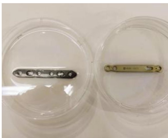
Figura 5: Placas ortopédicas utilizadas no experimento. A placa de cor preta, ao lado esquerdo da imagem, é a placa de titânio revestida com DLC; e a placa de cor amarela, ao lado direito, é a placa de titânio. Fonte: Próprio autor (2024).
