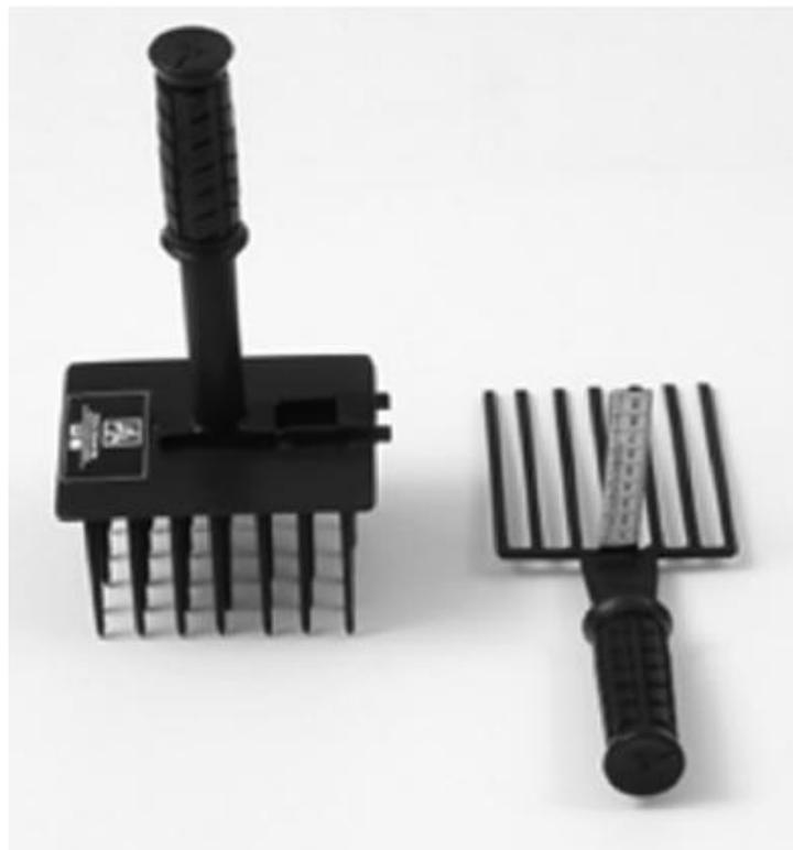
**Figura 11.** Coletor M-H para determinação direta da espessura da camada de necromassa fina. Fonte: Marimon-Junior e Hay (2008)
