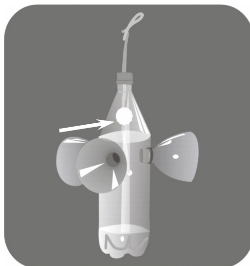
Figura 4. Esquema da armadilha confeccionada para captura dos machos de Euglossina . A seta indica o algodão contendo a isca aromática.
