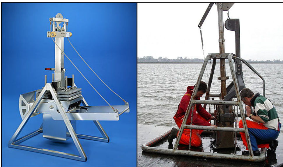
Figura 1.6: Amostradores do tipo caixa (Box-corer).
