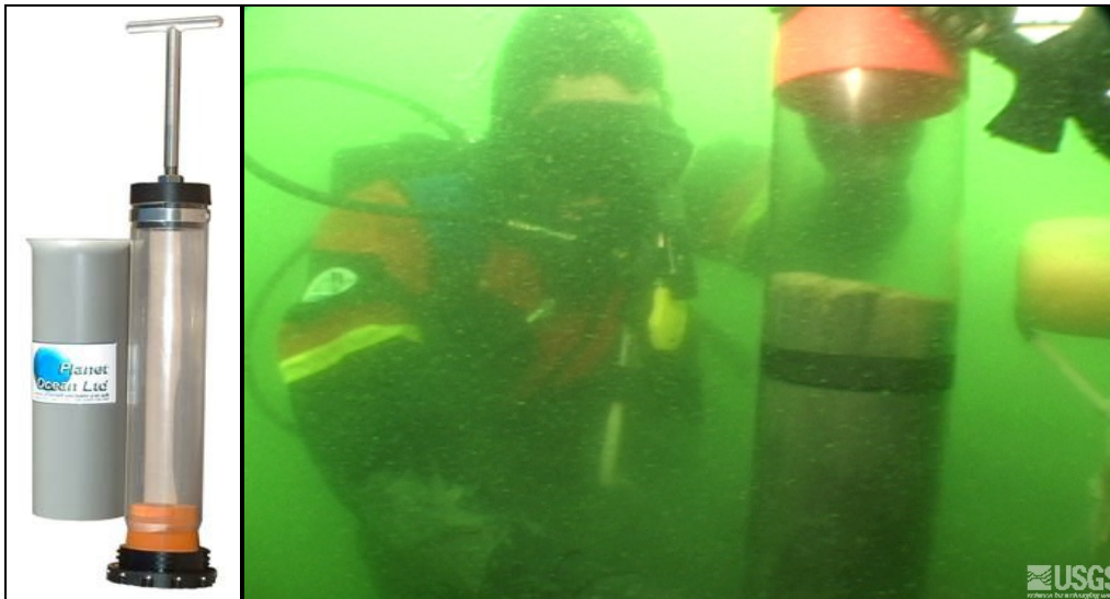
Figura 1.2: Tubo de amostragem do tipo Perspex (esquerda) e amostragem com tubo Perspex realizada no infralitoral por mergulhadores (direita).
