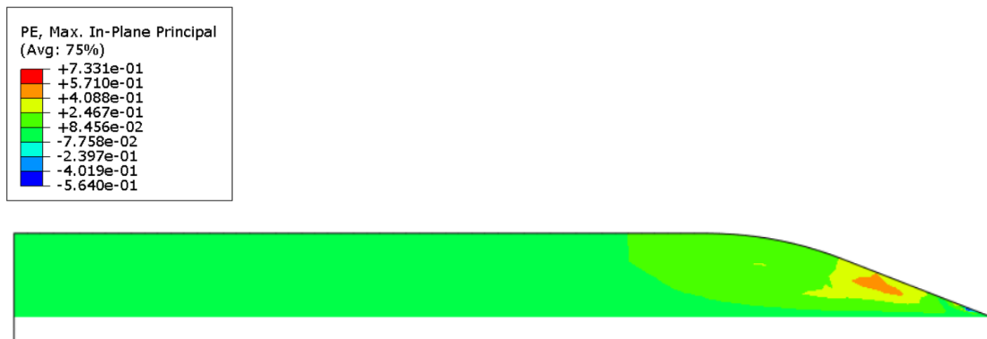
Figura 48 - Deformações plásticas após a etapa poropressão.
