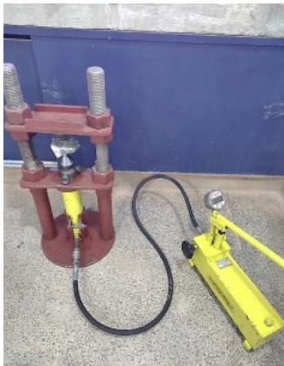
Figura 15-Point Load Test – equipamento da UENF.
