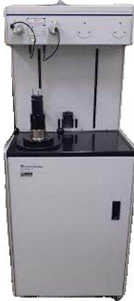
Figura 12-Porosímetro Autopore IV 9500 do Laboratório de Engenharia Civil da UENF.
