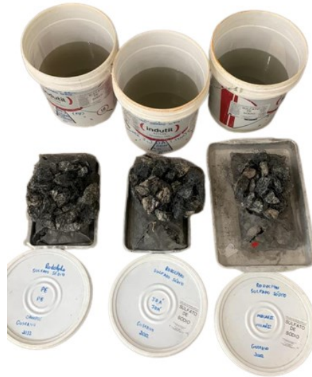
Figura 19- Processo de Ataque Por Sulfato De Sódio
