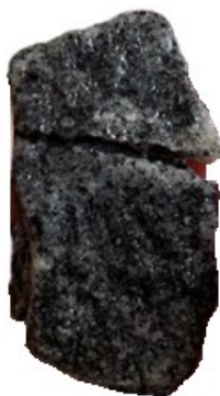
Figura 44- fragmentação pós 60 ciclos - ROCHA 03
