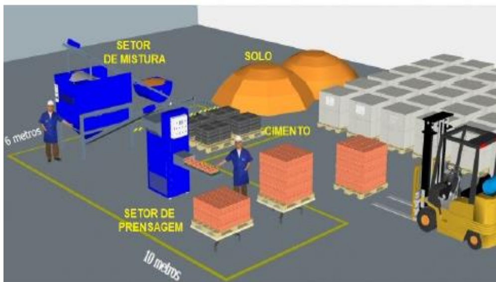
Figura 2-5 – Proposta de uma fábrica de tijolo solo-cimento
