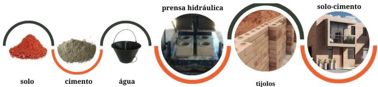
Figura 2-3 - Processo de Fabricação do Tijolo Solo-Cimento
