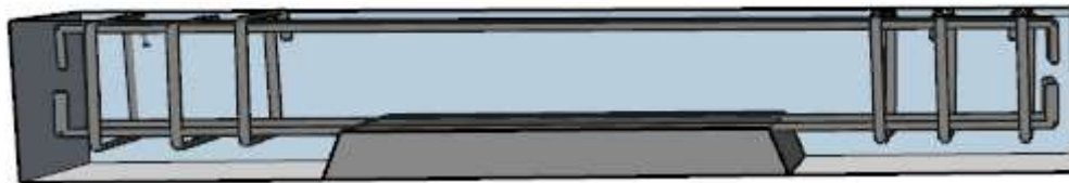
Figura 41 - Viga em 3D com as armaduras.
