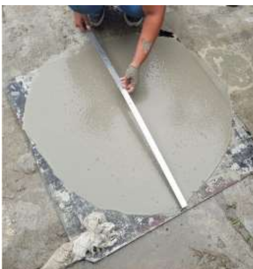
Figura 58 - Resultado do Slump flow e índice de Estabilidade visual do MCARG40.
