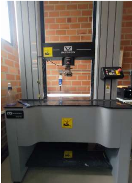
Figura 32 - Prensa utilizada nos ensaios de resistência à compressão e tração.
