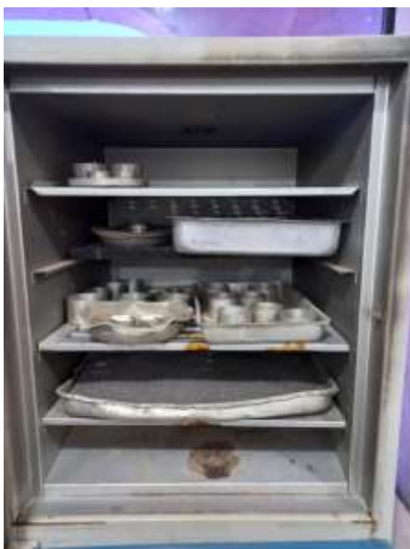
Figura 34 - Corpos de prova dentro da estufa depois de setenta e duas horas.
