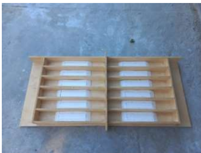
Figura 44 - Fôrma das vigas com entalhe de isopor.
