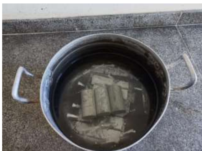
Figura 35 - Corpos de prova dentro da panela antes do período de fervura.
