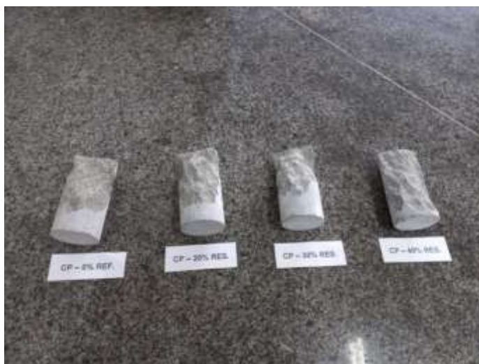
Figura 66 - Corpos de prova após o ensaio de resistência à compressão.
