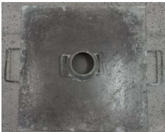
Figura 25 - Cone utilizado para fazer o Mini slump.
