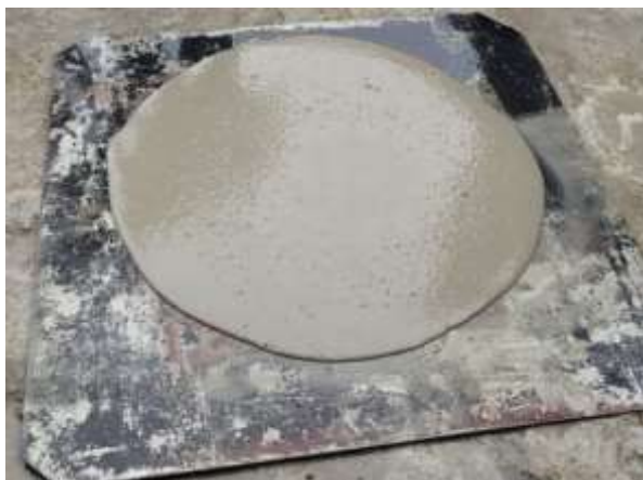
Figura 57 - Resultado do Slump flow e índice de estabilidade visual do MCARG30.
