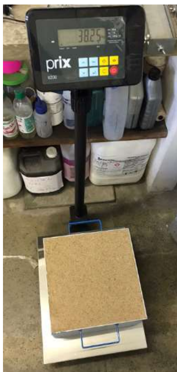
Figura 19 - Ensaio de massa unitária.
