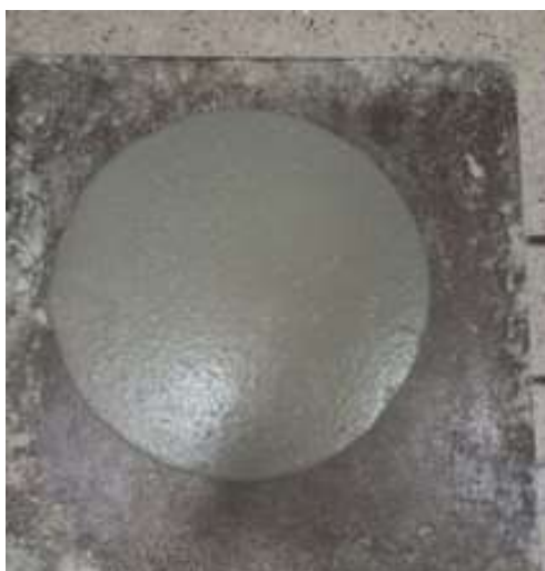
Figura 26 - Ensaio do Mini slump executado.
