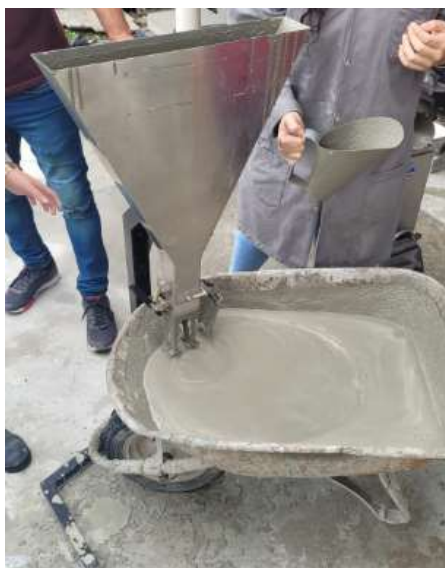
Figura 28 - Ensaio do Funil V.
