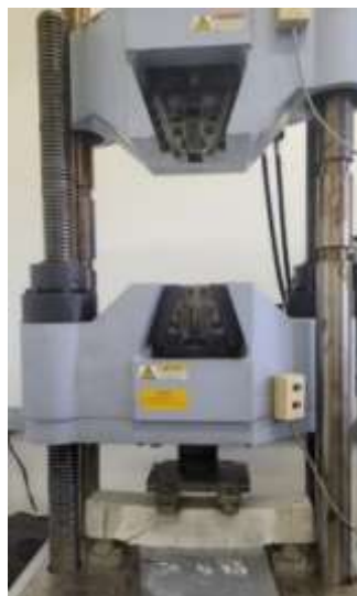
Figura 51 - Máquina da prensa executando o ensaio de flexão nas vigas.
