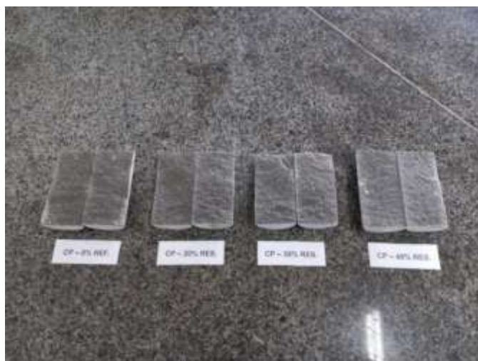
Figura 68 - Corpos de prova após o ensaio de resistência à tração por compressão diametral.
