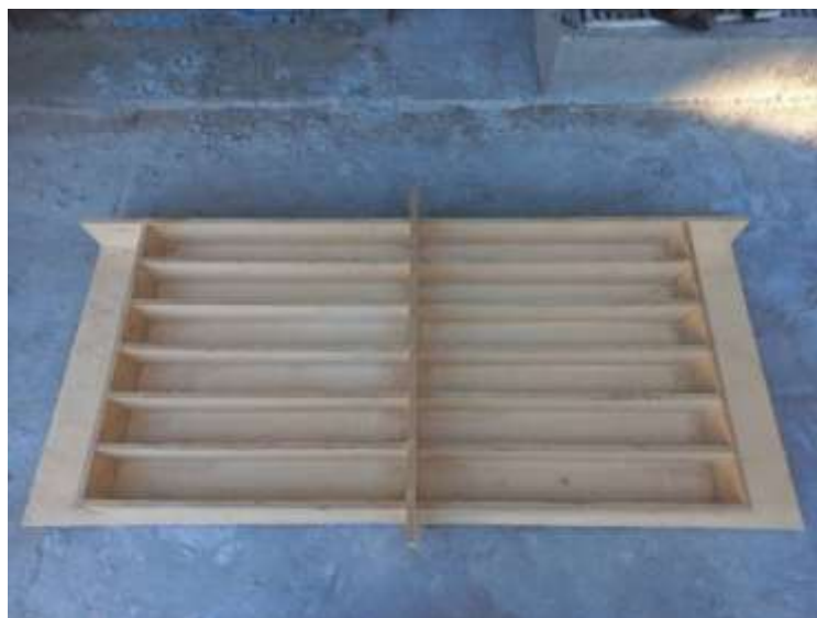
Figura 43 - Fôrma construída para a fabricação das vigas.
