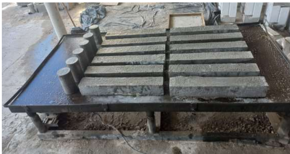
Figura 47 - Vigas e corpos de prova desmoldados.
