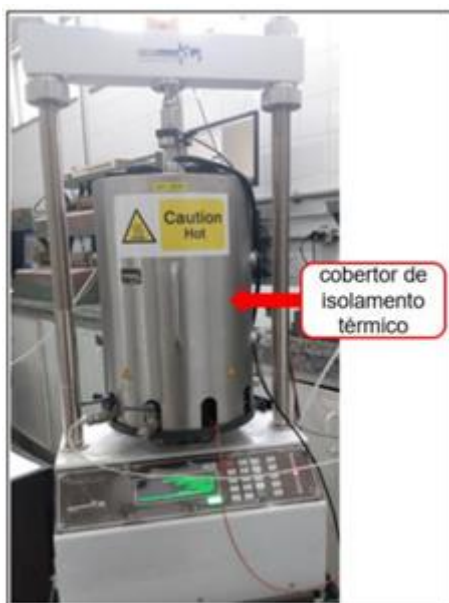
Figura 20 — Cobertor de isolamento térmico da célula triaxial térmica do laboratório de centrifuga geotécnica – UENF.
