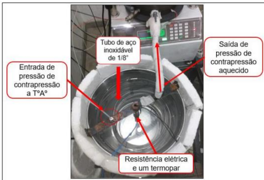
Figura 24 — Vista superior do sistema de aquecimento na direção de contrapressão.
