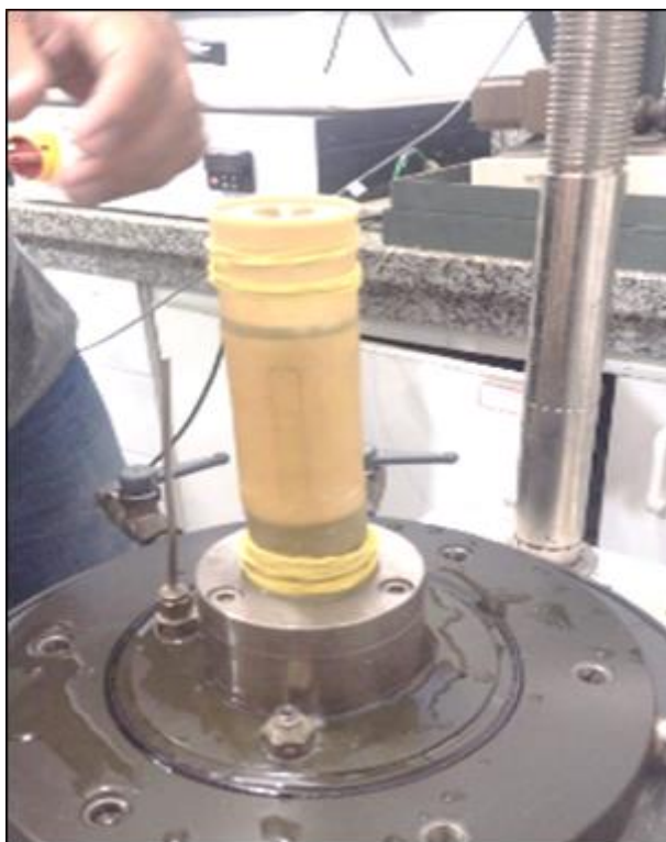
Figura 22 — Termopar interno (T1) do triaxial térmico adquirido pela centrifuga geotécnica da UENF.
