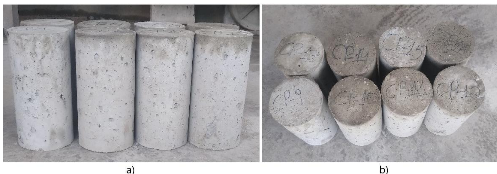
Figura 50 – Corpos de prova cilíndricos de concreto: a) corpos de prova vistos frontalmente; b) corpos de prova - vista superior.
