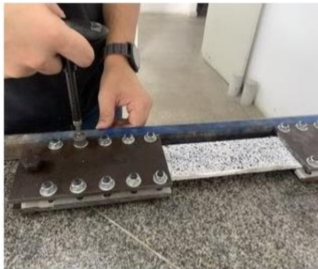
Figura 40 – Preparação dos corpos de prova para o ensaio de tração direta: a) lixas que foram coladas nas chapas de aço; b) processo de aperto dos parafusos com chave de torque manual.
