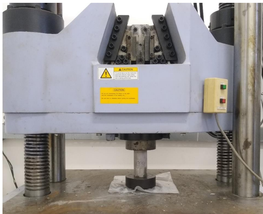
Figura 30 – Corpo de prova cilíndrico sendo ensaiado à compressão axial.
