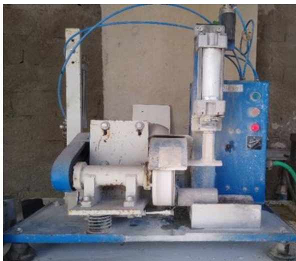
Figura 29 – Retificação dos corpos-de-prova cilíndricos.
