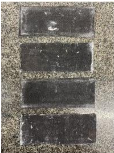
Figura 40 – Preparação dos corpos de prova para o ensaio de tração direta: a) lixas que foram coladas nas chapas de aço; b) processo de aperto dos parafusos com chave de torque manual.
