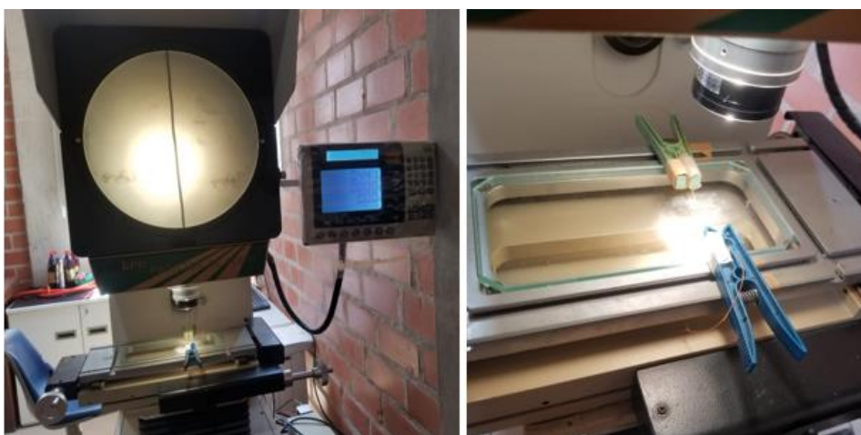
Figura 24 – Análise do diâmetro das fibras de sisal em projetor de perfil.
