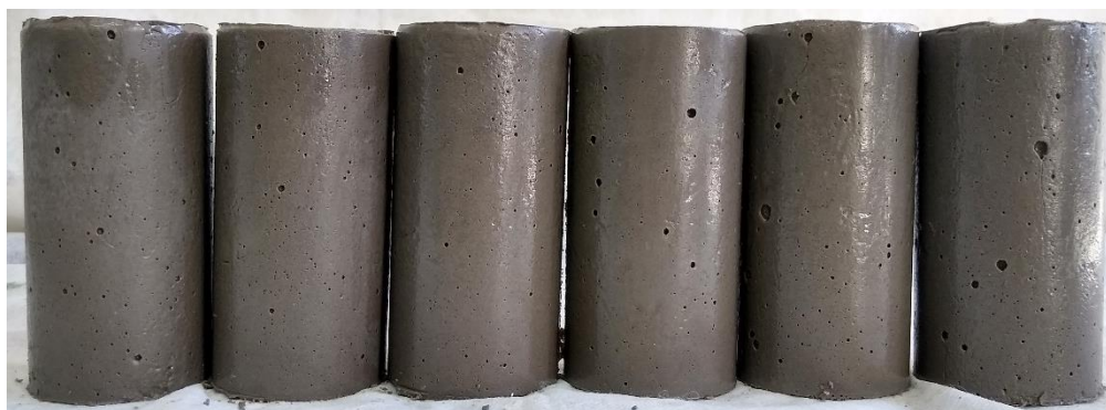
Figura 28 – Corpos de prova cilíndricos para caracterização mecânica da matriz geopolimérica.
