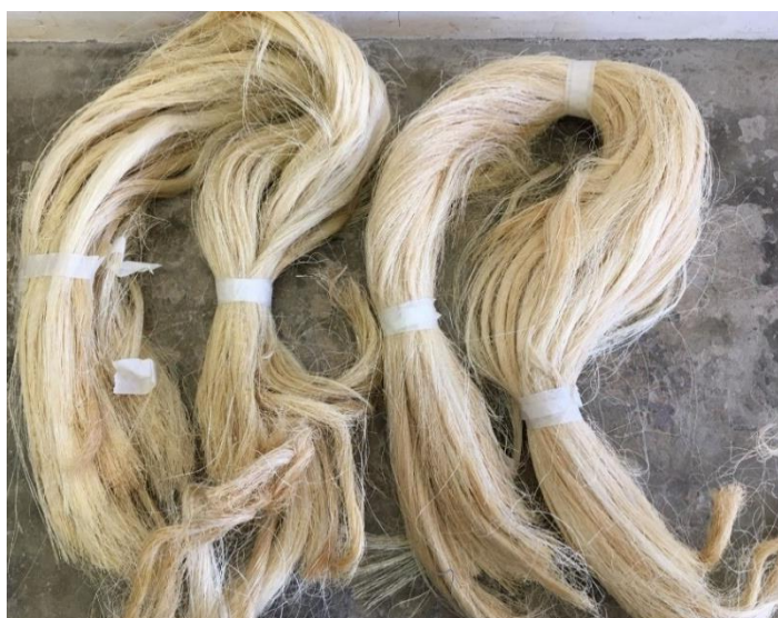
Figura 23 – Fibras de sisal como recebidas.
