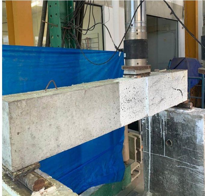
Figura 56 – Configuração do ensaio das vigas.
