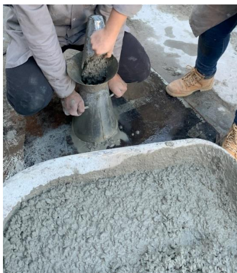
Figura 49 – Ensaio de abatimento de cone ( slump test ).
