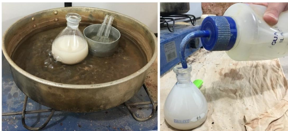
Figura 11 – Determinação da massa específica do metacaulim: a) processo de aquecimento do picnômetro em banho-maria; b) processo de preenchimento do picnômetro com água.
