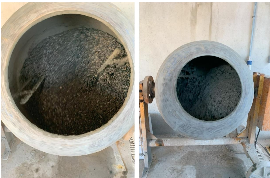
Figura 48 – Produção do concreto em betoneira: a) homogeneização do agregado graúdo com a água; b) mistura de todos os constituintes do concreto.
