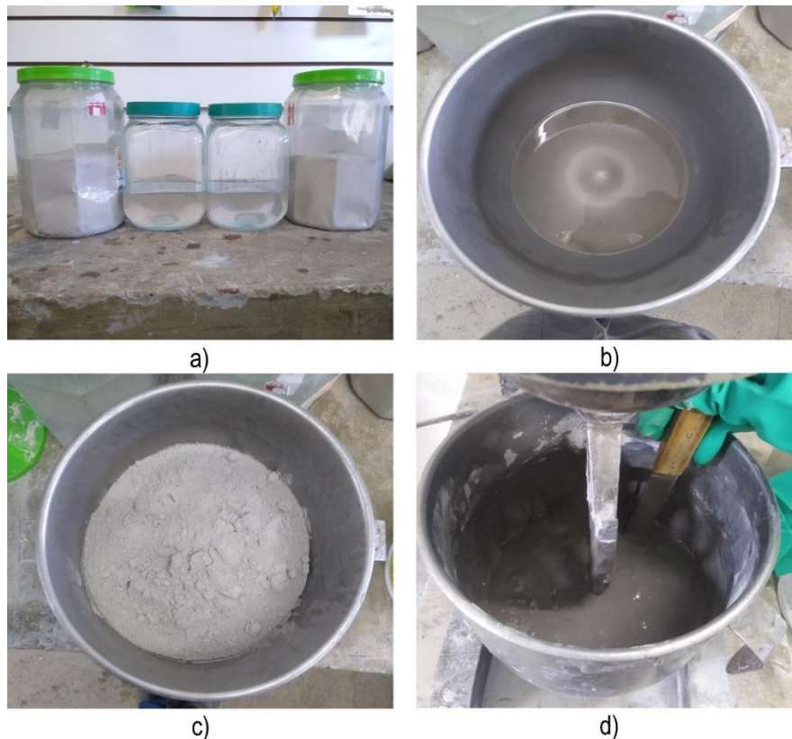
Figura 27 – Fabricação da matriz: a) solução ativadora alcalina e metacaulim + areia preparados previamente; b) solução ativadora alcalina na cuba; c) adição do metacaulim + areia à cuba; d) retirada dos materiais presos à parede e à pá da argamassadeira.
