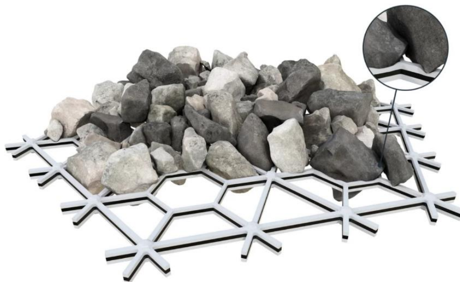
Figura 2.14 - Mecanismo de intertravamento das geogrelhas (Tensar, 2024).
