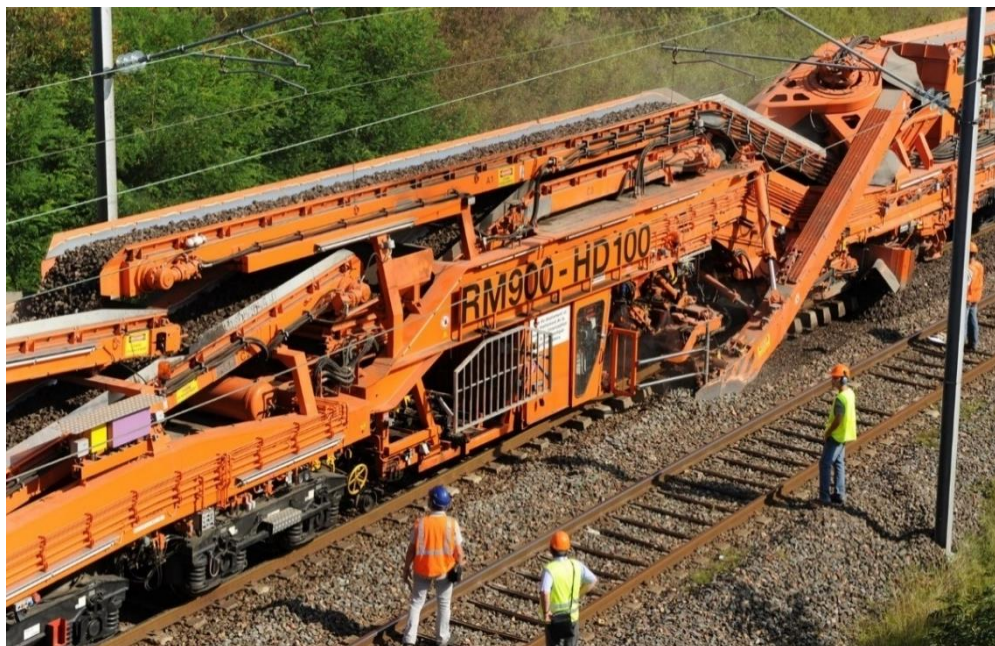
Figura 2.24 - Desguarnecedora de lastro (Plasser e Theurer, 2024).
