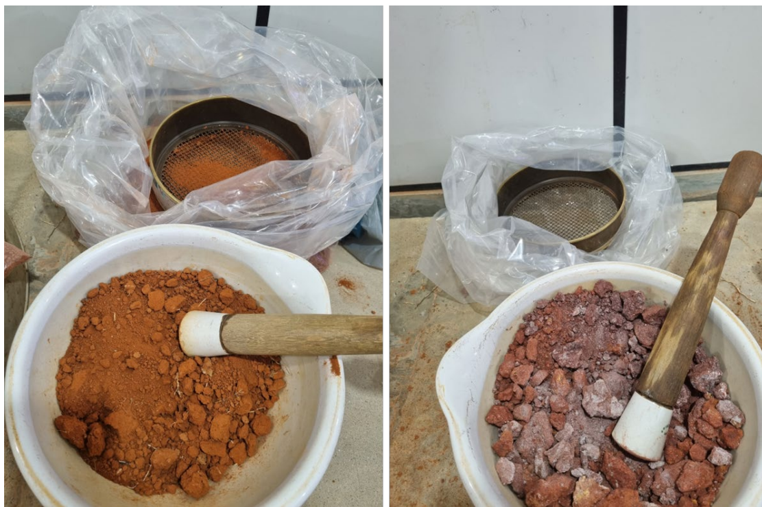
Figura 3.5 – Destorroamento e peneiramento dos solos coluvionar e jovem residual .
