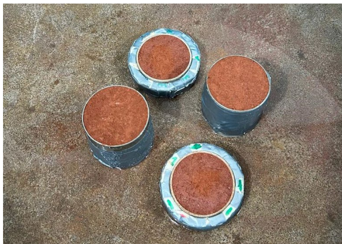
Figura 3.13 – Amostras de 20 e 50 mm sendo saturadas.
