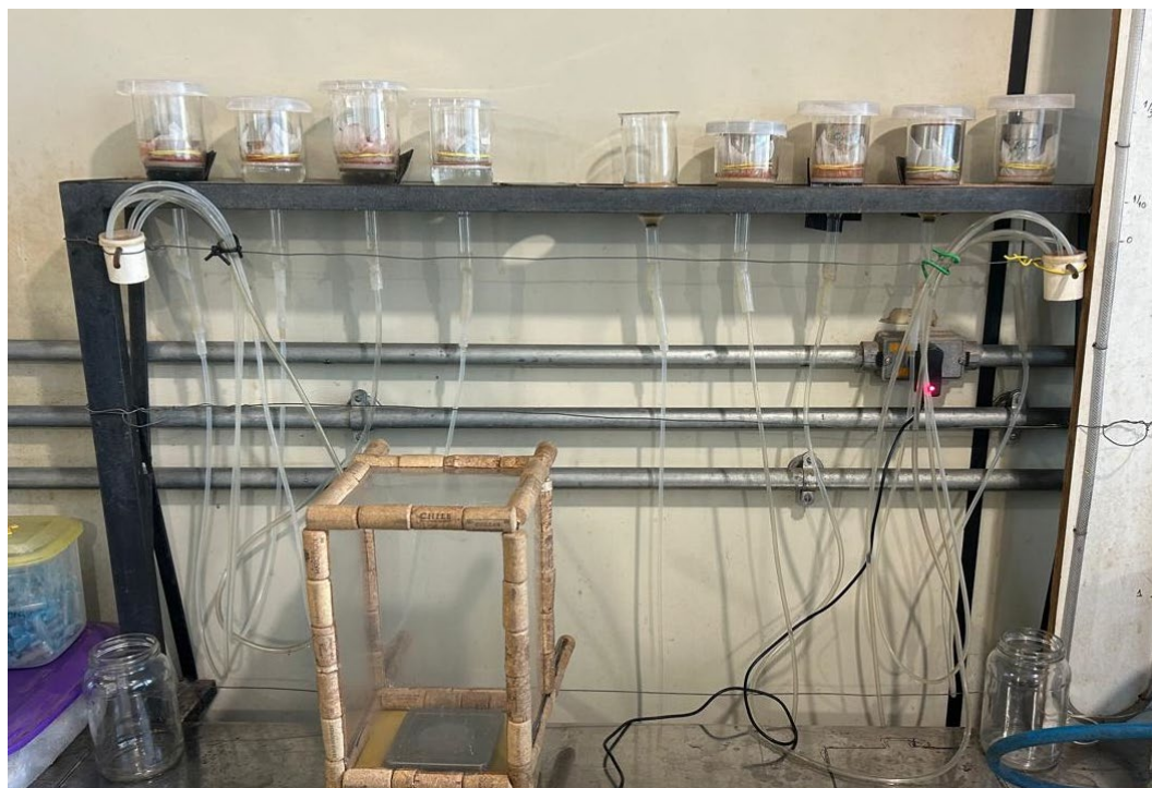
Figura 3.8 – Montagem e execução do ensaio funil de placa porosa.
