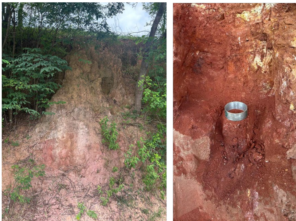
Figura 3.4 – Talude e extração do solo jovem residual indeformado.
