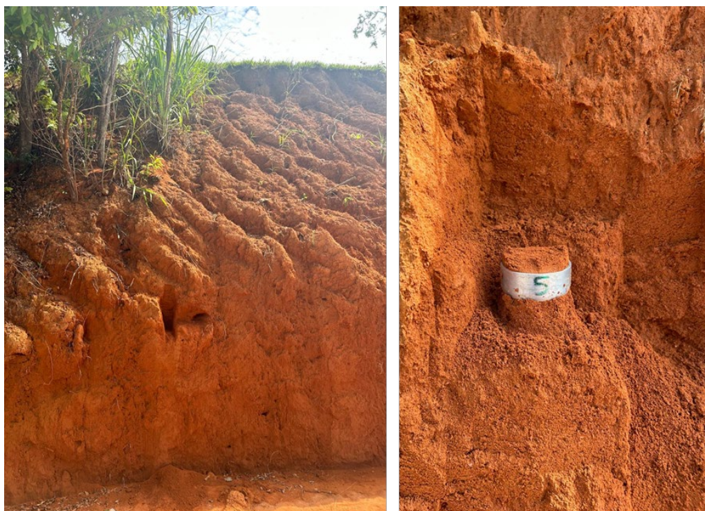
Figura 3.3 – Talude e extração do solo coluvionar indeformado.
