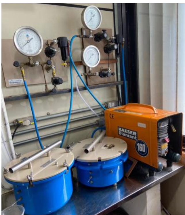
Figura 3.9 – Montagem e execução do ensaio câmara de pressão de Richards.
