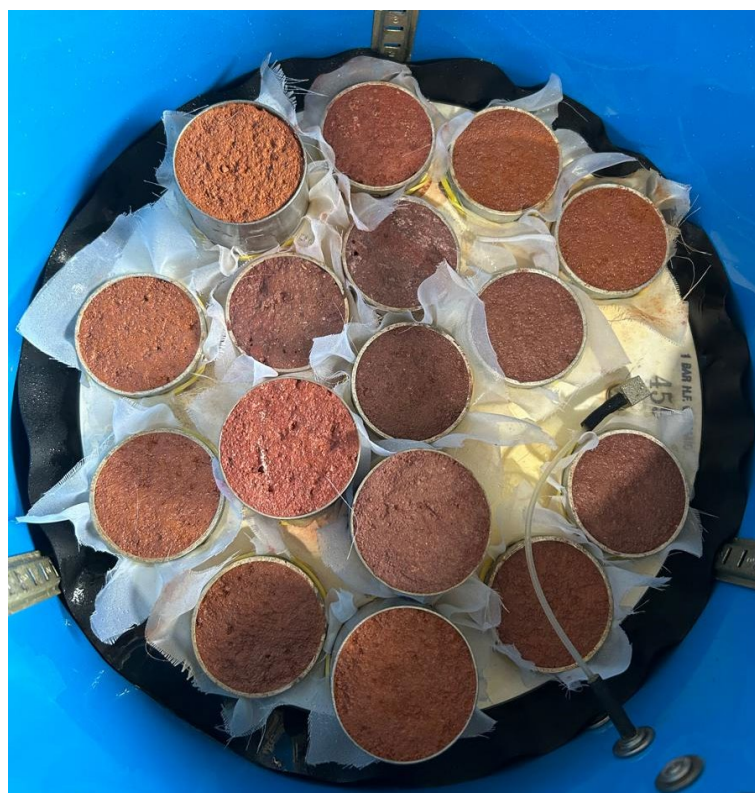
Figura 3.10 – Disposição das amostras ensaiadas na câmara de pressão de Richards.
