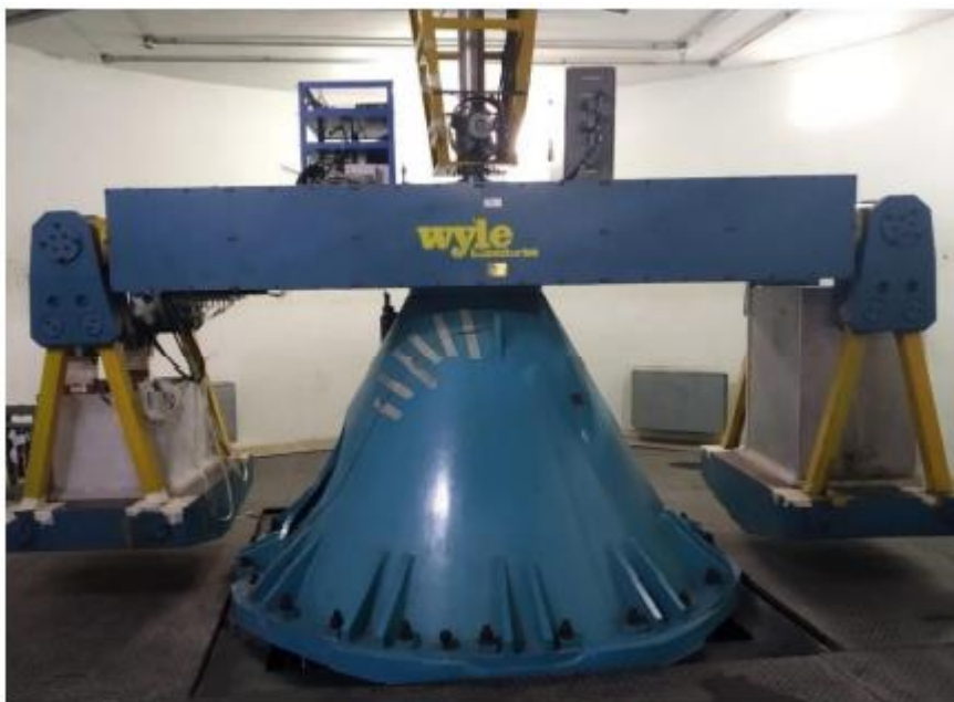
Figura 19 - Centrífuga de viga da UENF com o container do ensaio à esquerda e container de contrabalanceamento à direita
