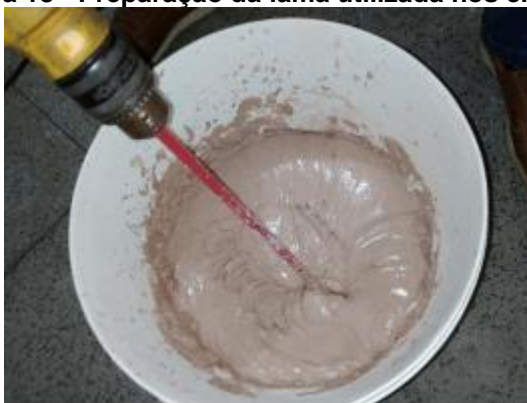
Figura 18 - Preparação da lama utilizada nos ensaios
