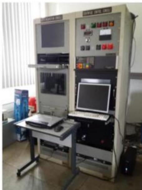
Figura 20 - Central de controle da centrífuga
