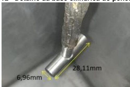
Figura 12 - Detalhe da base cilíndrica do penetrômetro
