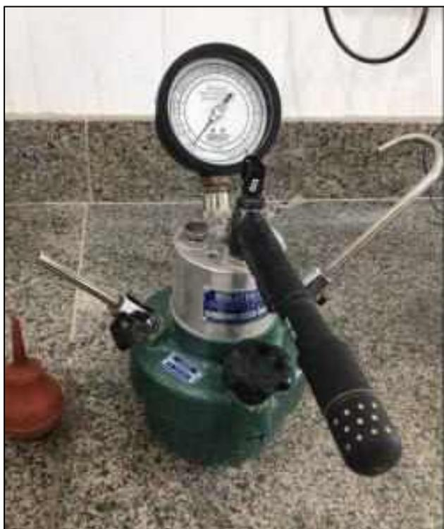
Figura 17: Aparelho para análise de teor de ar incorporado da marca Solotest
