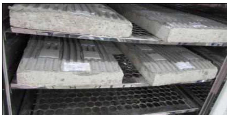
Figura 22: Conjunto submetido a cura em estufa a temperatura de  $70^\circ$
