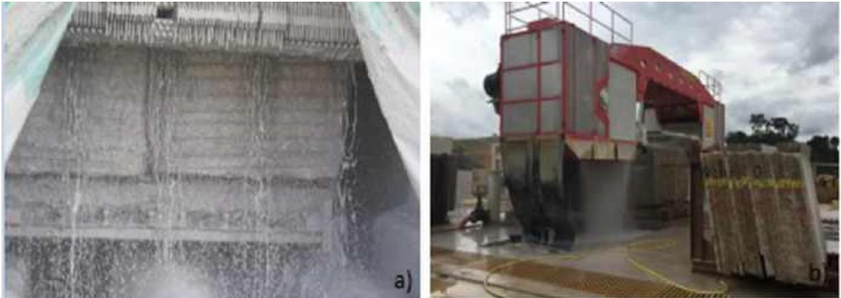
Figura 5: a) Teares multilâminas de aço. b) Teares multifios diamantados
