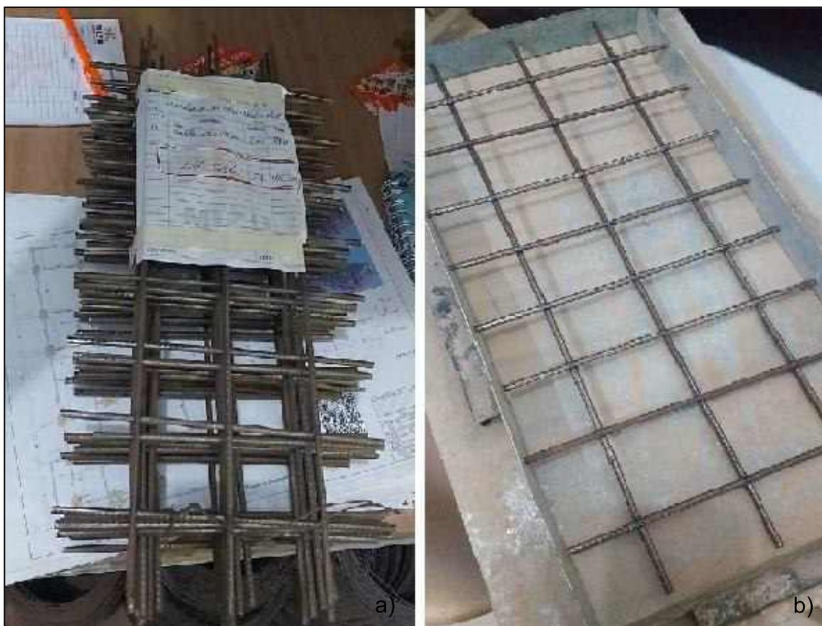
Figura 13: a) Armaduras confeccionadas; b) Conjunto armadura e forma
