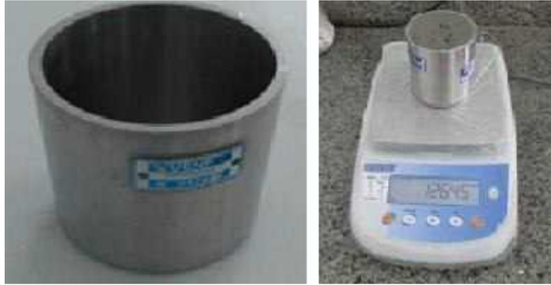
Figura 16: a) Recipiente para densidade de massa b) Conjunto balança de precisão e recipiente da marca Solotest
