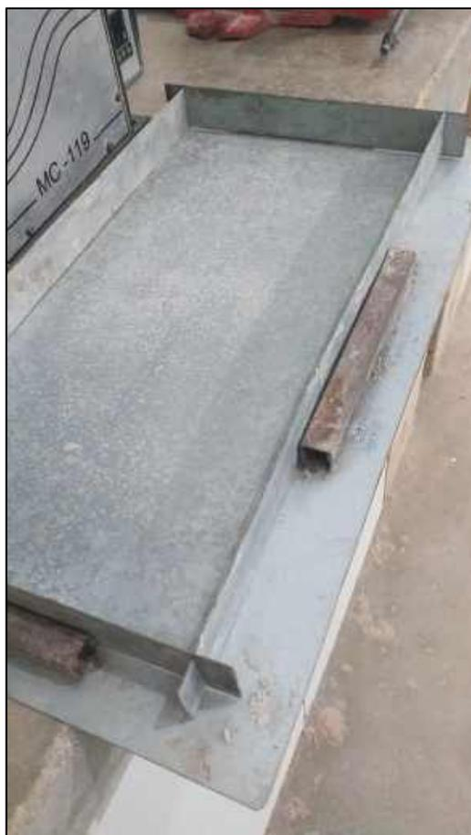
Figura 12: Forma metálica utilizada para confecção dos substratos
