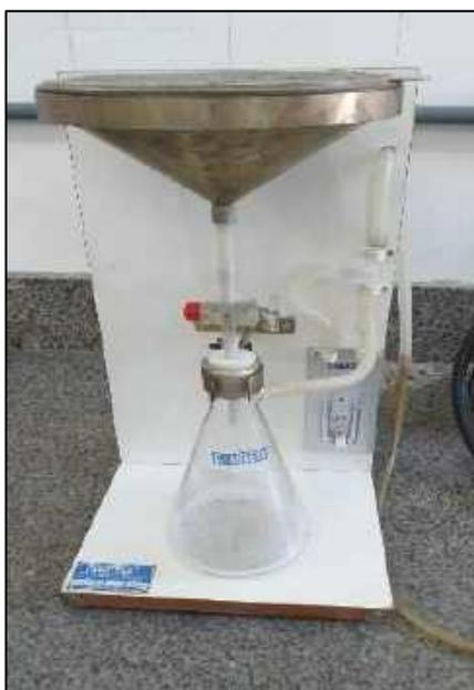
Figura 15: - Aparelho para retenção de água em argamassas da marca Solotest
