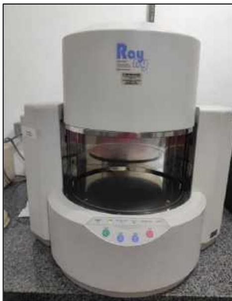
Figura 14: Aparelho para análise química EDX-7000 Shimadzu
