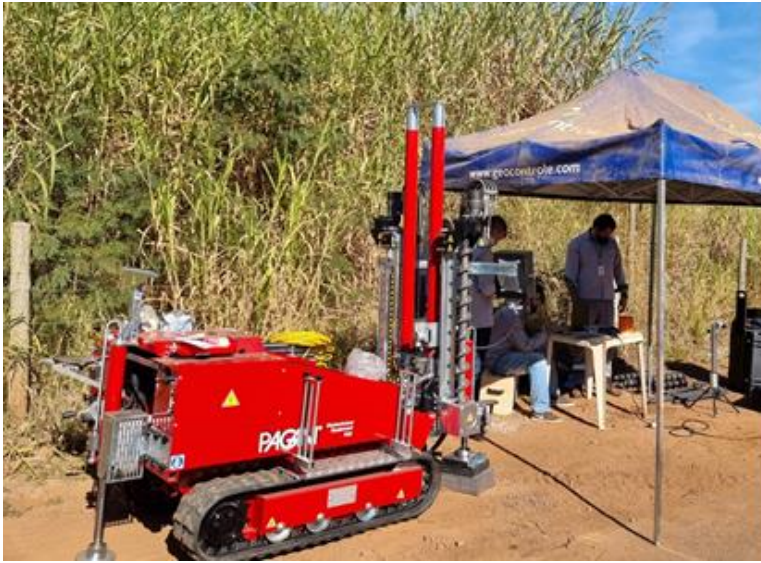
Figura 17 – Equipamento de ensaio CPTu, Pagani T63.
