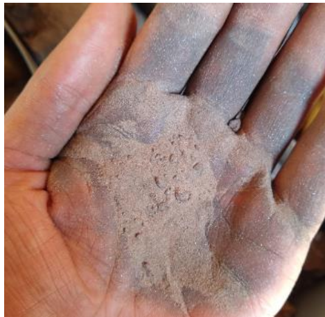
Figura 22 – Aspecto táctil-visual do rejeito arenoso presente na barragem analisada.
