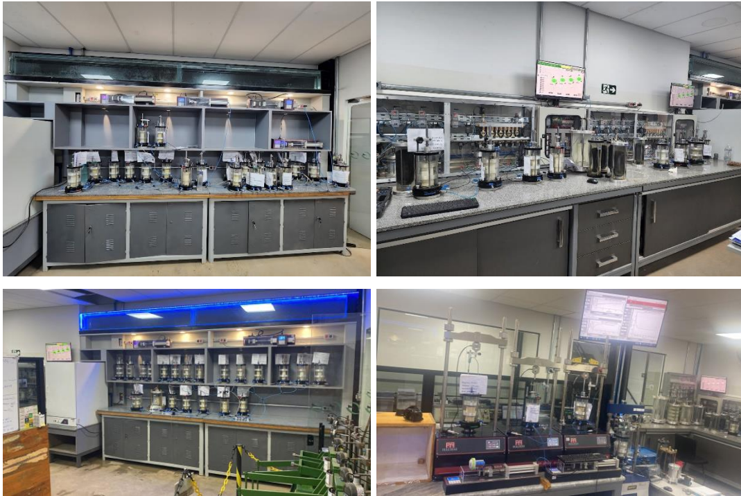
Figura 20 – Infraestrutura de laboratório de mecânica dos solos da Geocontrol. São destacadas as bancadas com as câmaras de ensaios triaxiais e as presas de cisalhamento.
