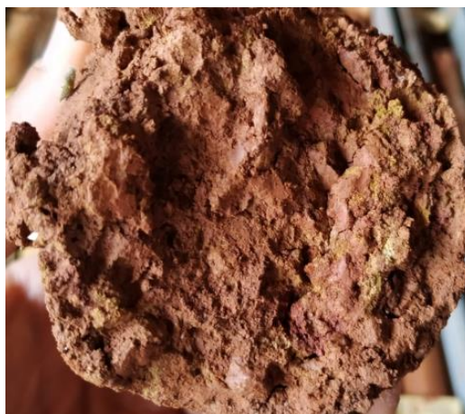
Figura 23 – Característica macroscópica da textura do aterro do dique de partida obtido de testemunho de sondagem mista.
