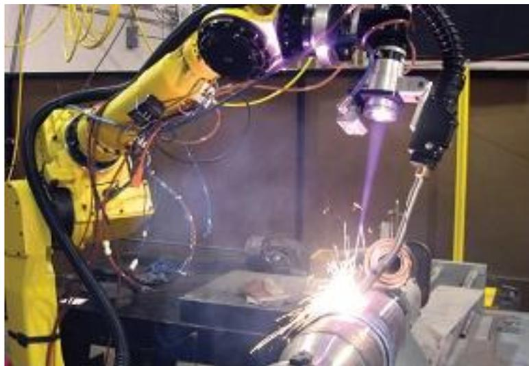
Figura 1: Laser híbrido com GMAW utilizado para revestimento (Cortesia, Alabama Laser, [s.d.]).
