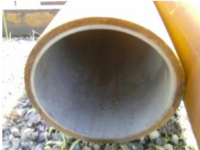
Figura 9: API 5L X-65 com INCONEL 625 co-extrudado (Cortesia Schulz, 2010).
