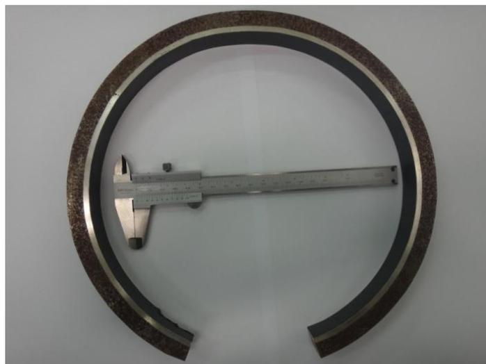
Figura 23: Seção do tubo da soldagem por explosão.
