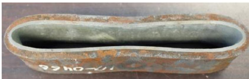
Figura 10: API 5L X-65 com INCONEL 625 co-extrudado, após teste de achatamento (Cortesia Schulz, 2010).
