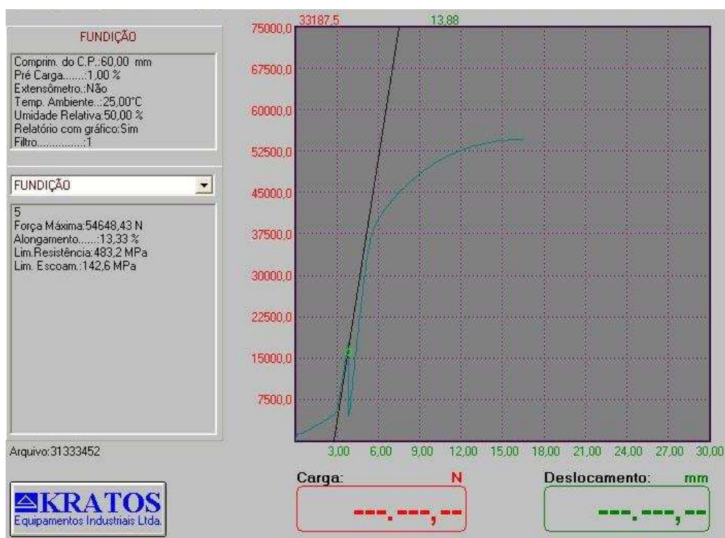
Figura 106 – Curva de ensaio de tração de ferro fundido nodular T5 (30min / 1261 °C). 2º lote.
