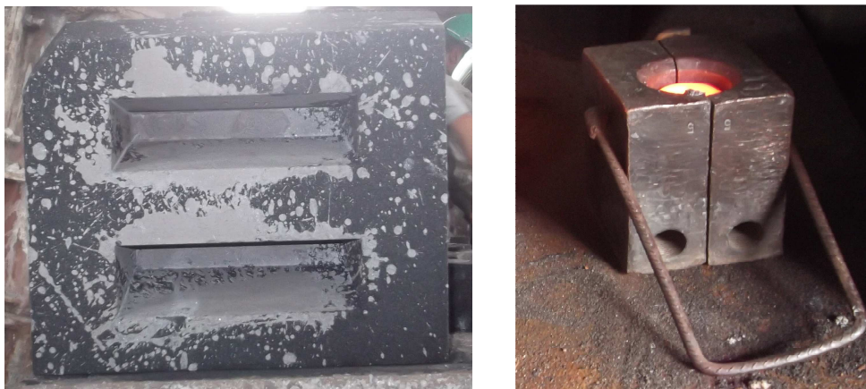
Figura 54 – Moldes para obtenção de amostras (a) CP e CP Ybloc, (b) pastilhas coquilhadas.
