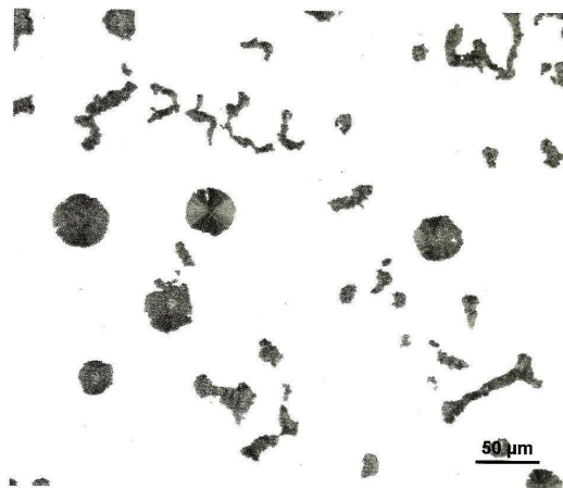
Figura 48 – Micrografia de ferro fundido nodular contendo grafita vermicular. Aumento: 200X (Guesser, 2009).
