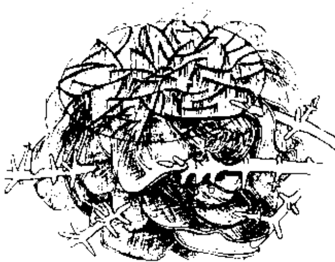
Figura 25 – Dendritas de austenita e célula eutética (grafita + austenita) em ferro fundido cinzento. A grafita é contínua na célula eutética e apresenta a forma de plaquetas (Morrogh, 1960).
