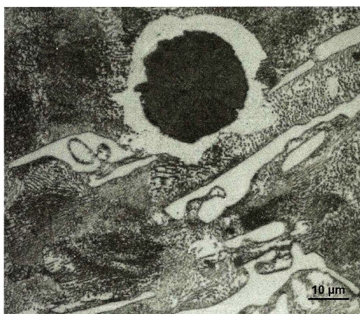
Figura 51 – Cementita em ferro fundido nodular. Aumento: 1000X (Guesser, 2009).
