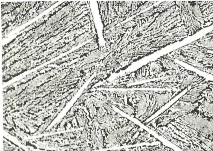
Figura 8 – Micrografia de um ferro fundido branco hipereutético. A estrutura apresenta longos cristais de cementita sobre uma matriz de ledeburita. Aumento 150X (Chiaverini, 2002)
