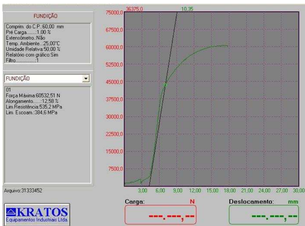
Figura 102 – Curva de ensaio de tração de ferro fundido nodular T1 (10min / 1361 °C). 2º lote.
