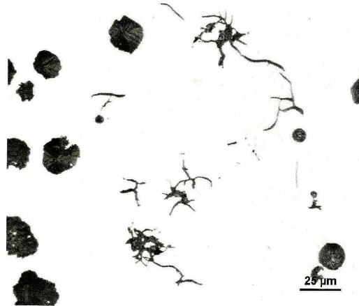
Figura 49 - Micrografia de ferro fundido nodular contendo grafita “ Spiky ”. Aumento: 400X (Guesser, 2009).
