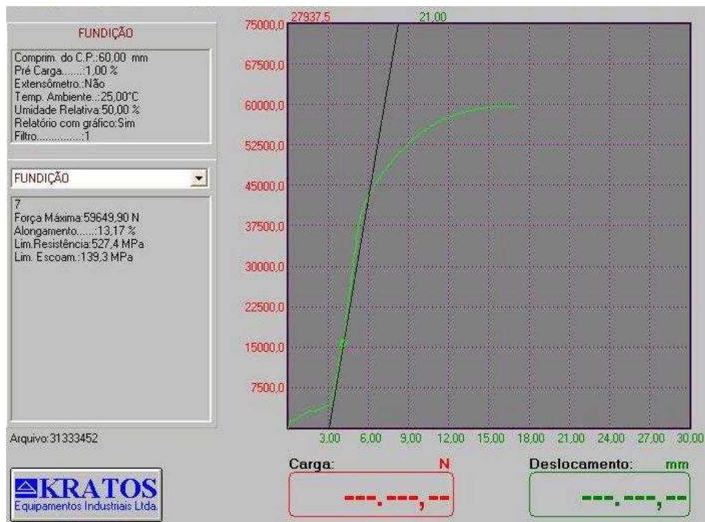
Figura 108 – Curva de ensaio de tração de ferro fundido nodular T7 (40min / 1236 °C). 2º lote.
