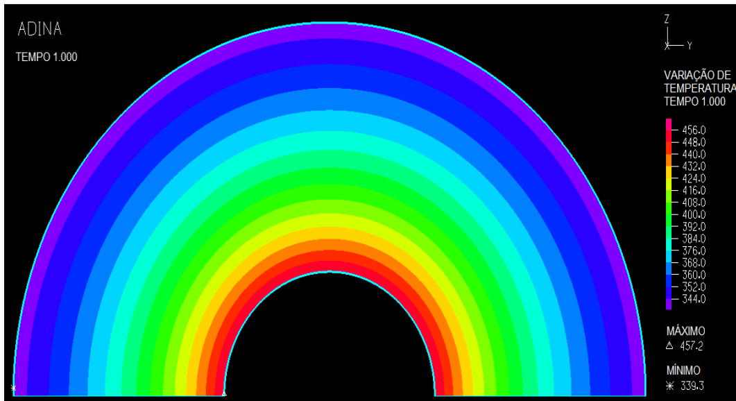
Figura 4.4: Ilustração da análise da distribuição de temperatura para tubo perfeito via MEF (convecção).
