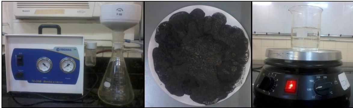
Figura 3.4: Procedimento para extração de sais do resíduo.
