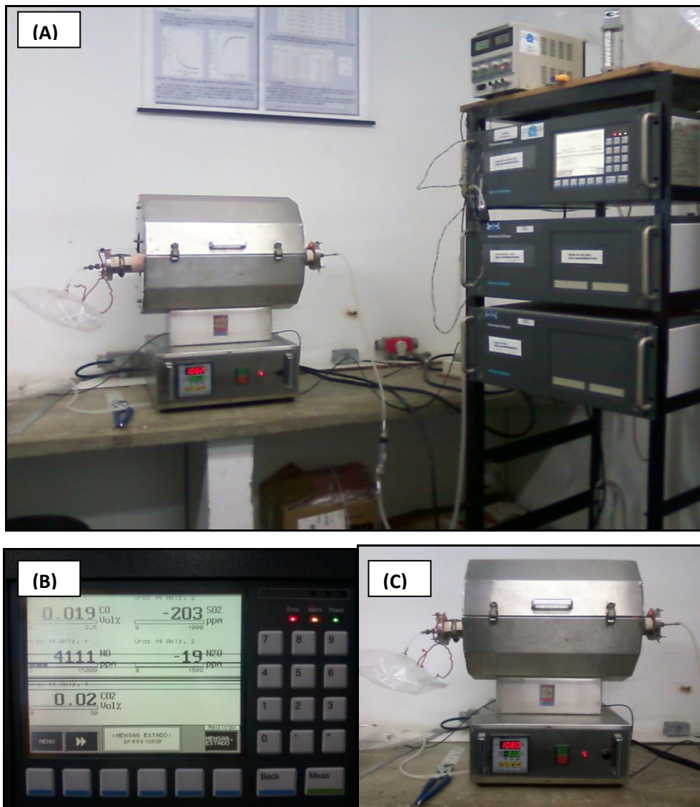
Figura 3.7: Equipamento utilizado para medir a emissão de gases pelas peças cerâmicas – URAS (B) e Forno (C).
