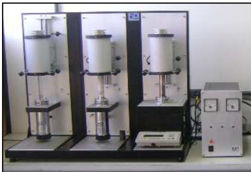
Figura 64. Termogravímetro BP 300 (LAMAV/CCT/UENF).
