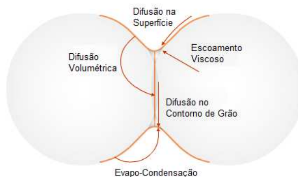
Figura 17. Mecanismos de transporte de massa no processo de sinterização por fase sólida (adaptado de Hlavác, 1983).
