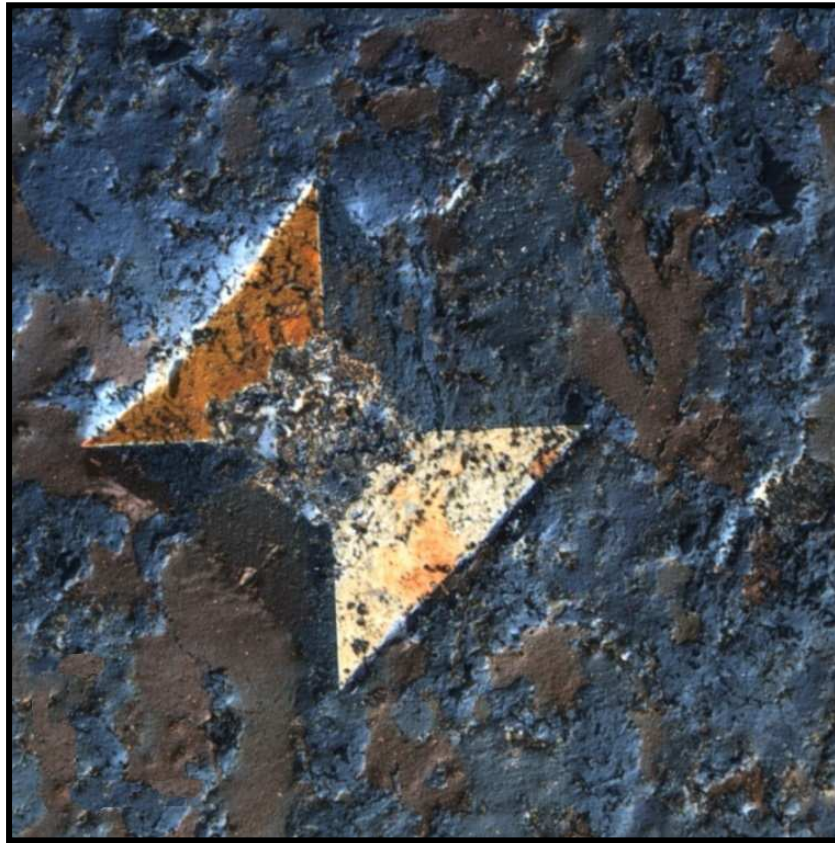
Figura 98. Impressão do ensaio de dureza Vickers para uma amostra do tipo M1, com adição de diamantes (800 °C/ 9 min / 34 MPa) (1000x).
