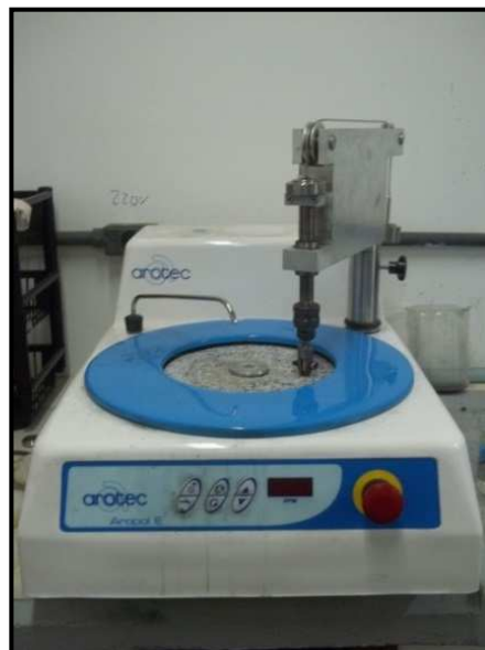
Figura 68. Politriz utilizada nos ensaios de desgaste (LAMAV/CCT/UENF).
