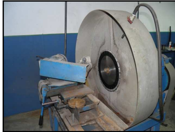
Figura 71. Retífica usada no processo de limpeza e rebarbação das serras circulares (ABRASDI, 2013).
