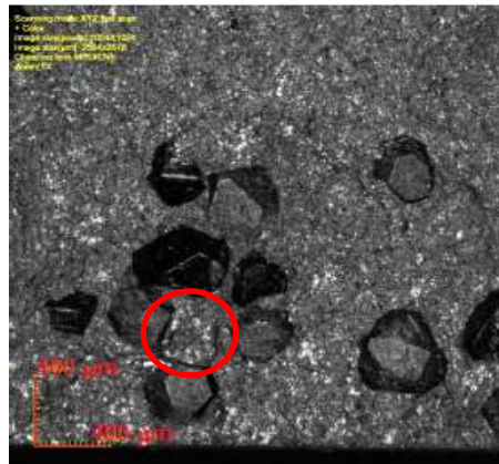
Figura 28. Micrografia mostrando a ocorrência de pull out sobre a superfície de uma matriz de um compósito diamantado (Liang et al. , 2002).
