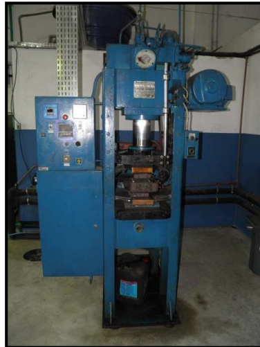
Figura 56. Prensa hidráulica EKA modelo PHB30.REF220 (ABRASDI, 2013).
