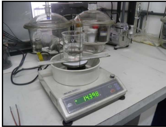
Figura 61. Montagem para medição de densidade por Arquimedes.
