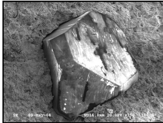
Figura 30. Micrografia de um cristal de diamante sem revestimento aderido à matriz metálica (x150) (Yu et al. , 2006).
