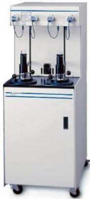
Figura 62. Porosímetro de mercúrio Poresizer 9320 (LAMAV/CCT/UENF).
