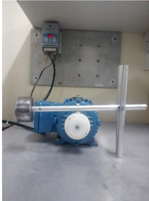
Figura 17 – Sistema montado para os testes abrasivos
