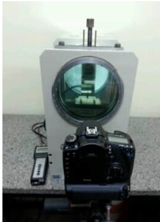
Figura 15 – Ensaio da fotoelasticidade dos sistemas DGEBA no Polariscópio
