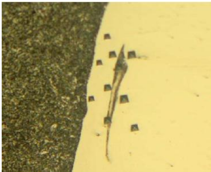
Figura 19- Estrutura típica de ilha da ZPD (Kejelin, 2006).
