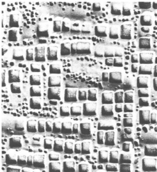
Figura 9- Precipitação de \gamma' cuboidal em matriz austenítica (Stoloff, 2005)
