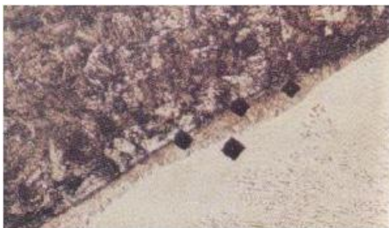
Figura 17- Estrutura típica de praia da ZPD (Kejelin, 2006).
