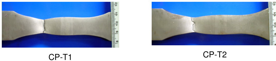
Figura 5.20 – Corpos de prova após a ruptura no ensaio de tração
