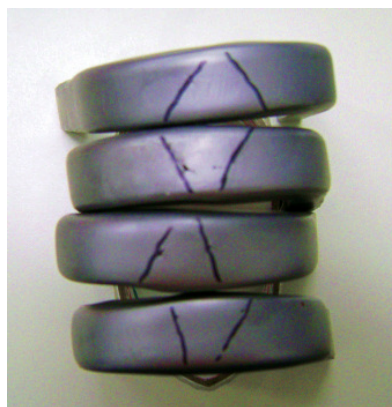
Corpos de prova após o ensaio de dobramento
