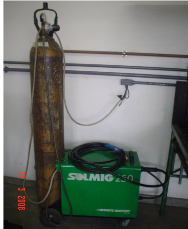
Figura 4.2 – Conjunto máquina de solda e gás de proteção utilizados na soldagem pelo processo GMAW
