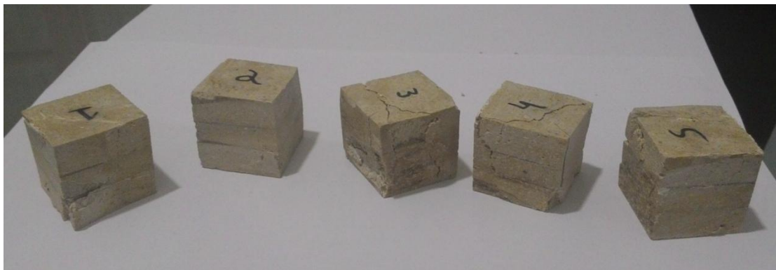
Figura 31 – Aspecto macroscópico da ruptura de amostras de compósitos de epóxi com diferentes frações de volume de resíduo de vidro.
