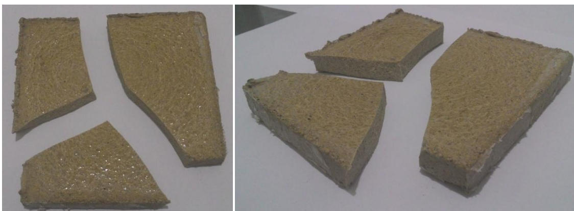
Figura 32 – Aspecto típico dos corpos de prova após o ensaio de impacto de corpo duro
