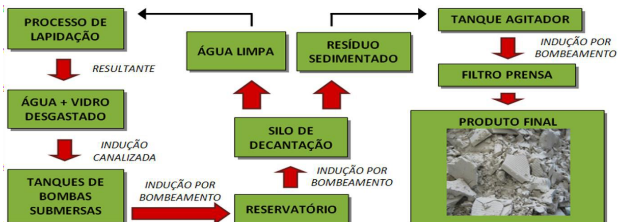
Figura 16 – Fluxograma do processo de obtenção do resíduo de vidro (Antônio, 2012).
