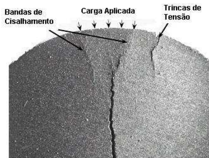
Figura 4.8 – Danos causados no disco após o carregamento referente à etapa 5 até fim do teste (Jonsén et al. , 2007).
