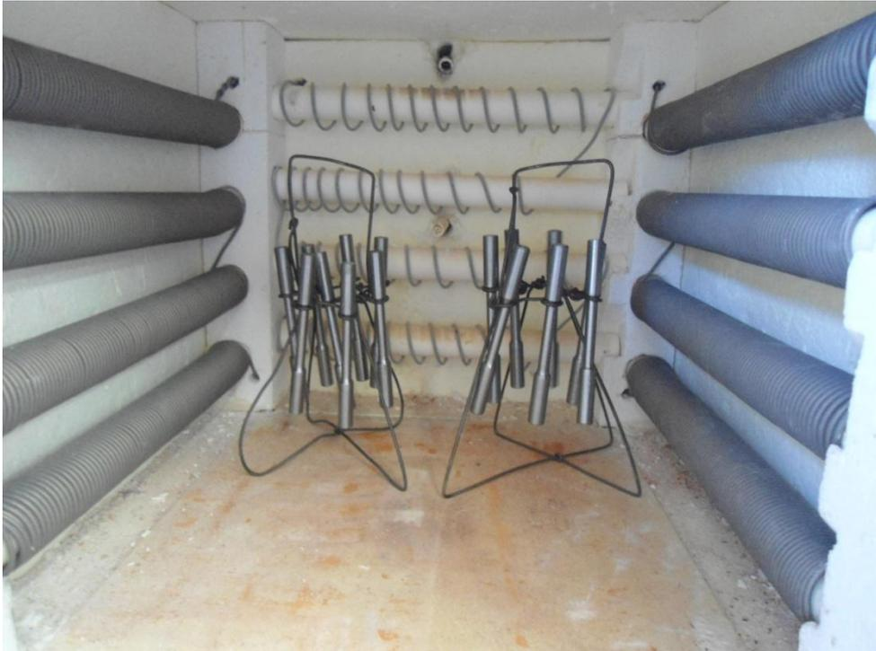
**Figura 37:** Corpos de prova de tração dispostos no interior do forno
