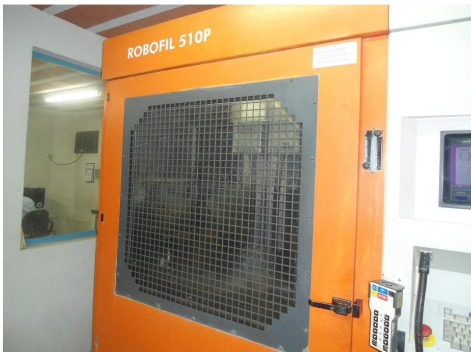
**Figura 28:** Equipamento de Eletroerosão utilizado para abertura dos entalhes
