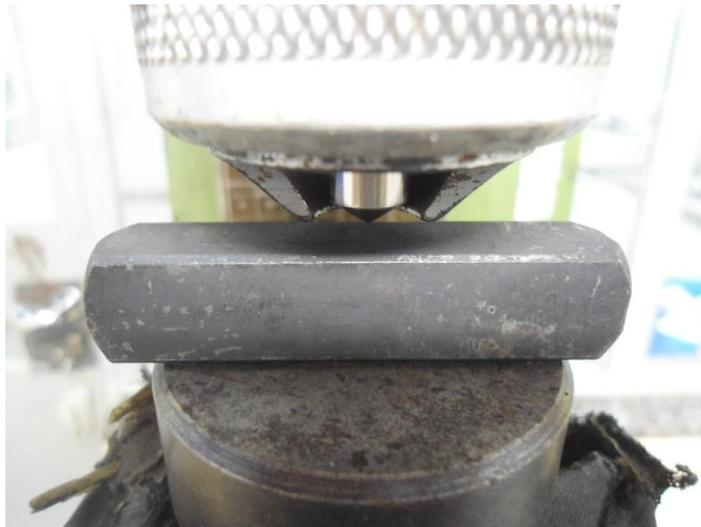
**Figura 45:** Amostra posicionada para ensaio de dureza
