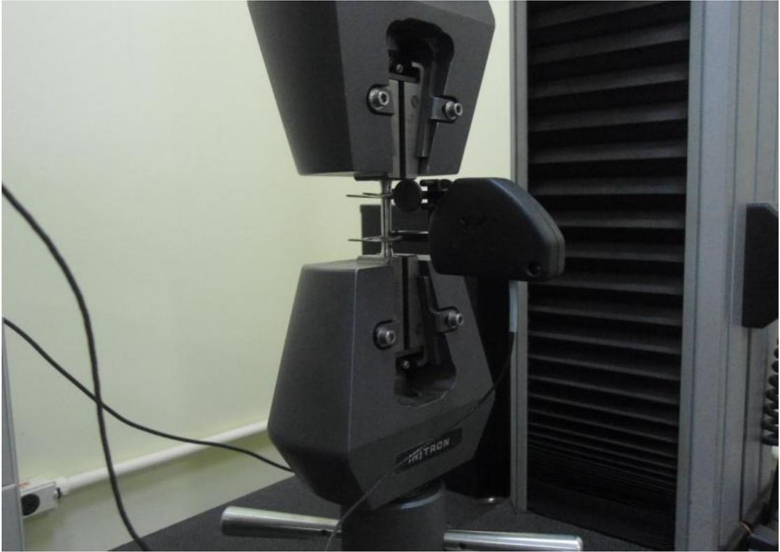
**Figura 47:** Corpo de prova com extensômetro acoplado para realização do ensaio.
