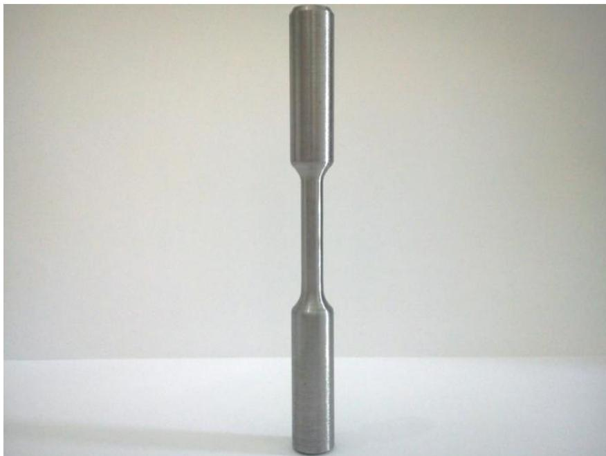
**Figura 35:** Corpo de prova de tração
