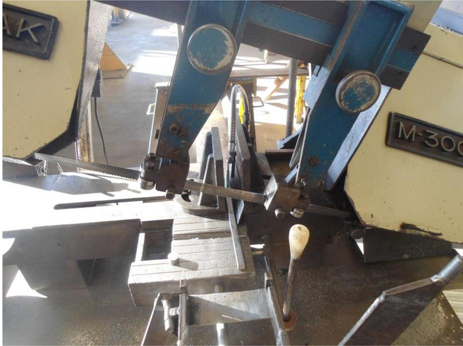
**Figura 27:** Corte das amostras em serra fita
