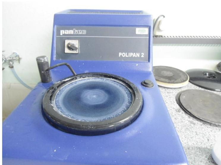
**Figura 44:** Lixadeira utilizada para preparação das amostras para ensaios metalográficos.
