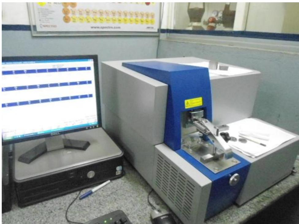
**Figura 25:** Espectrofotômetro de emissão óptica utilizado para realização das análises químicas.
