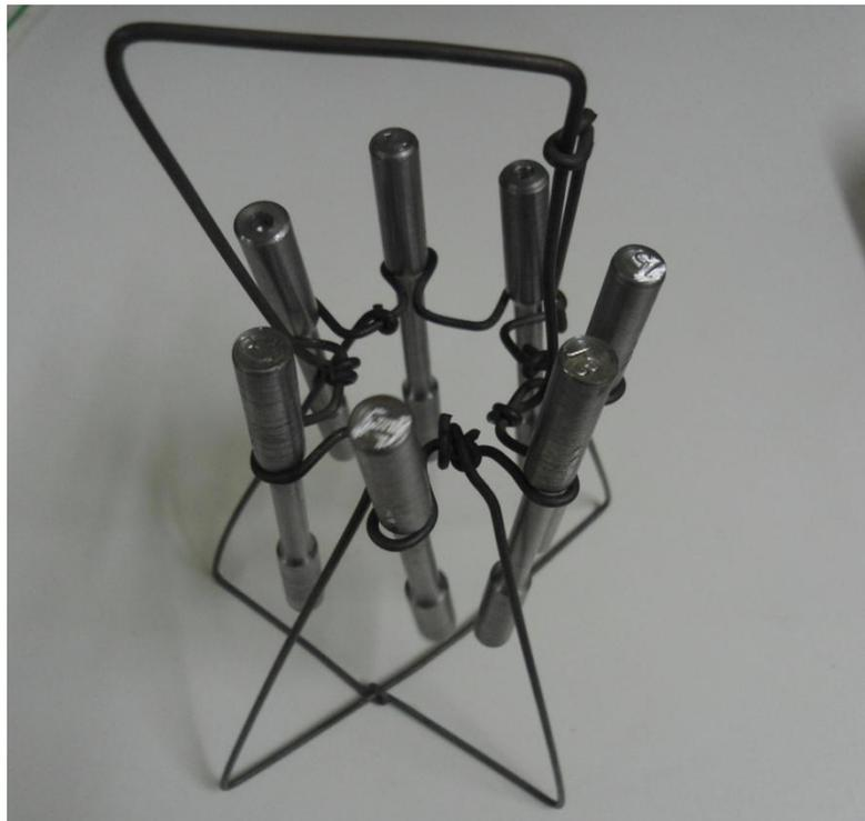
**Figura 36:** Corpos de prova de tração dispostos no suporte
