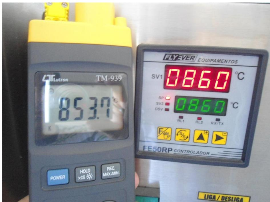
**Figura 39:** Monitoramento da temperatura interna do forno
