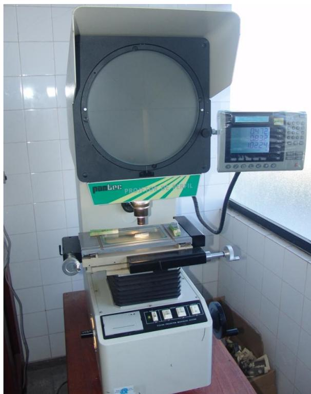
**Figura 30:** Projetor de perfil utilizado para observar entalhe dos corpos de prova de Tenacidade à Fratura
