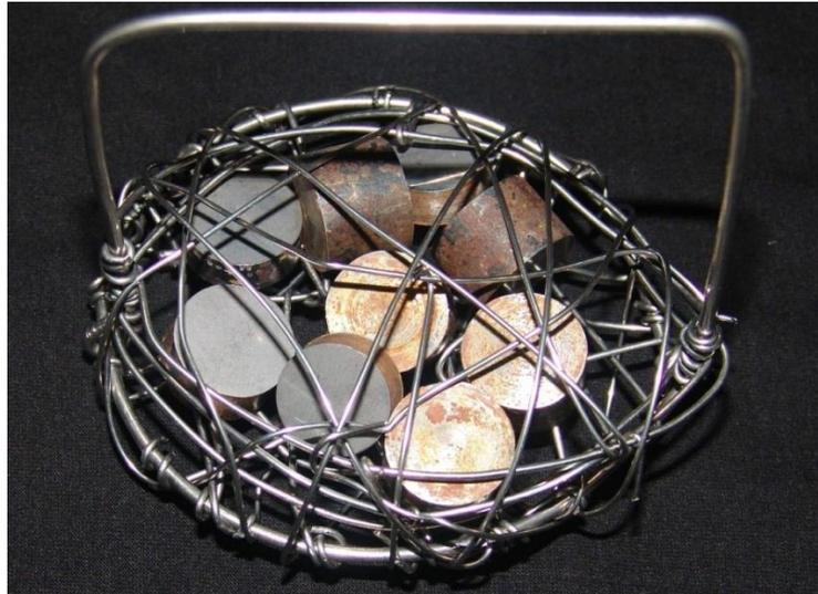
Figura 32 – Cesta de imersão das amostras para análise metalográfica.
