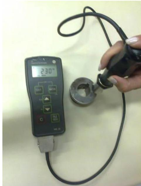
Figura 36 – Durômetro utilizado para a medição do aço em estudo.
