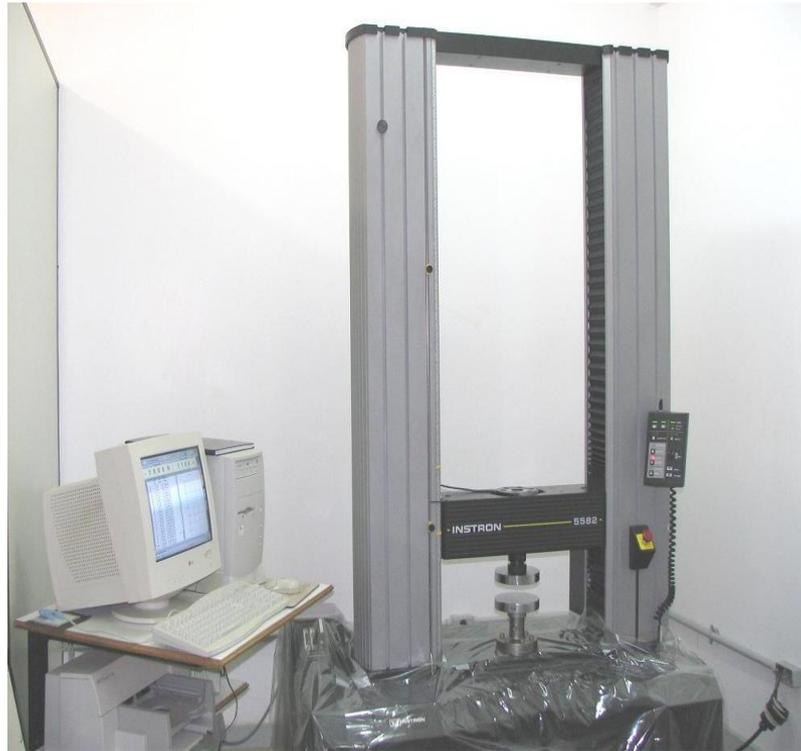
Figura 37 - Máquina universal de ensaios mecânicos Instron modelo 5582.
