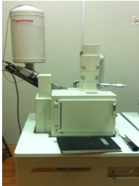
**Figura 30 - Microscópio Eletrônico de Varredura (MEV), disponível na COPPE – UFRJ.**
