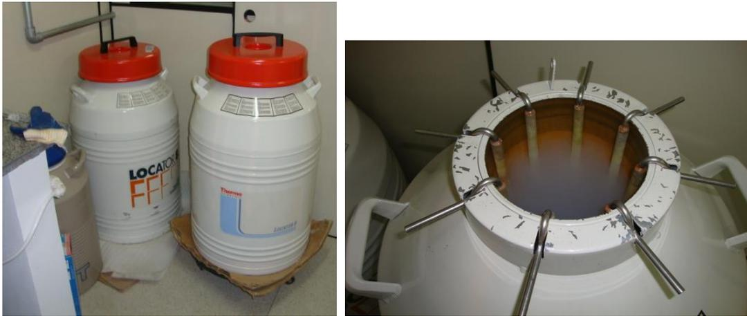
Figura 29 - Container com Nitrogênio líquido.
