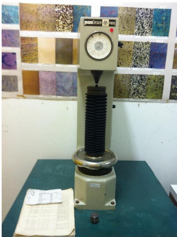
**Figura 33 - Durômetro utilizado para a medição do aço em estudo.**
