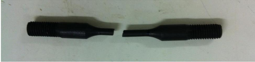
**Figura 32 - CP fraturado, após o ensaio de tração.**
