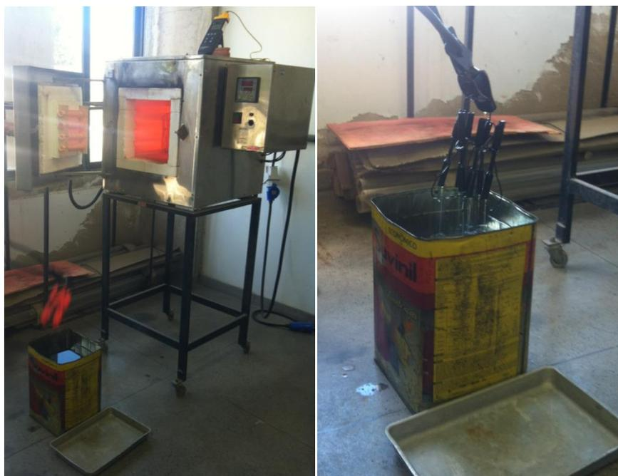
**Figura 27 - CP's submetidos à têmpera**
