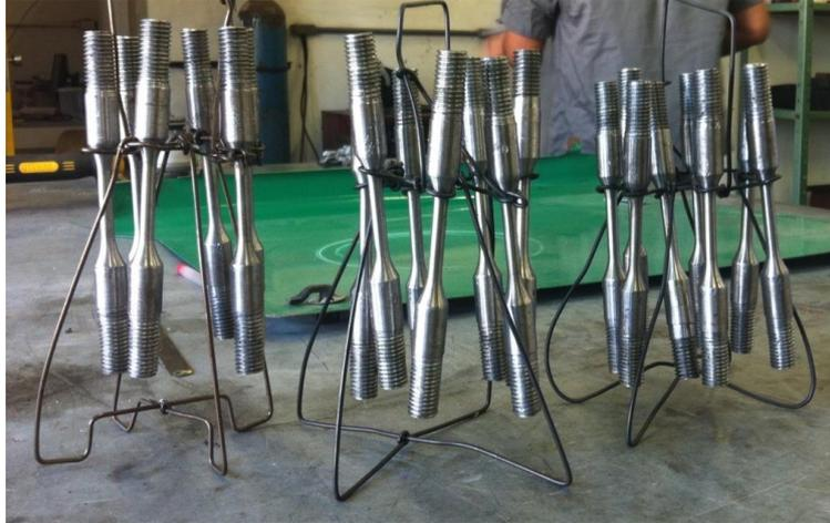
**Figura 25 - CP's dispostos no suporte, preparados para sofrer o tratamento térmico.**
