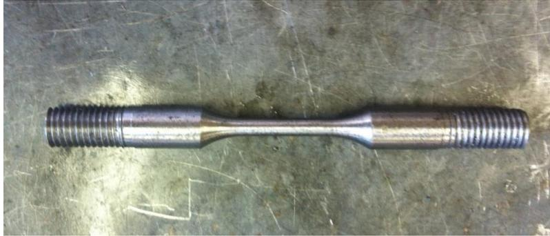
**Figura 23 - Corpo de prova usinado com rosca, anti-escorregamento.**
